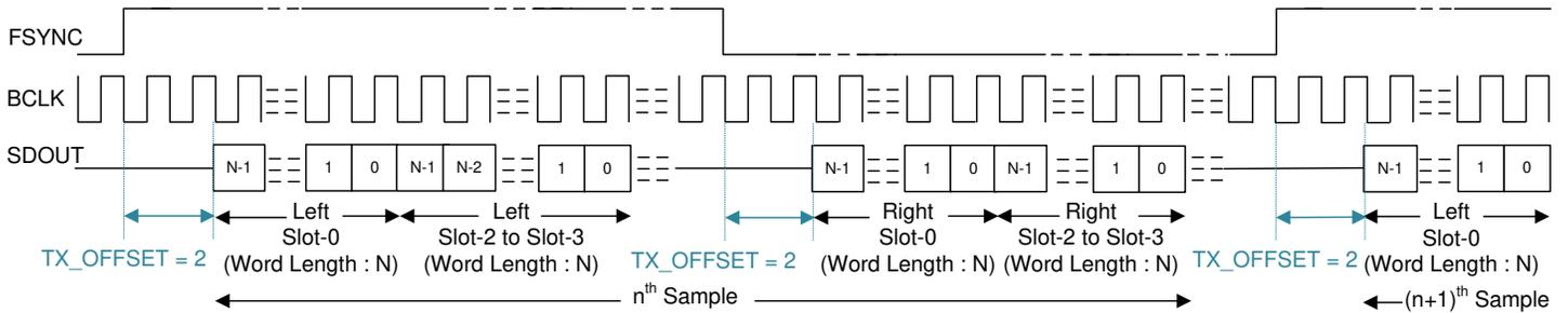
图 6-10. LJ 协议时序 (TX\_OFFSET = 2)
