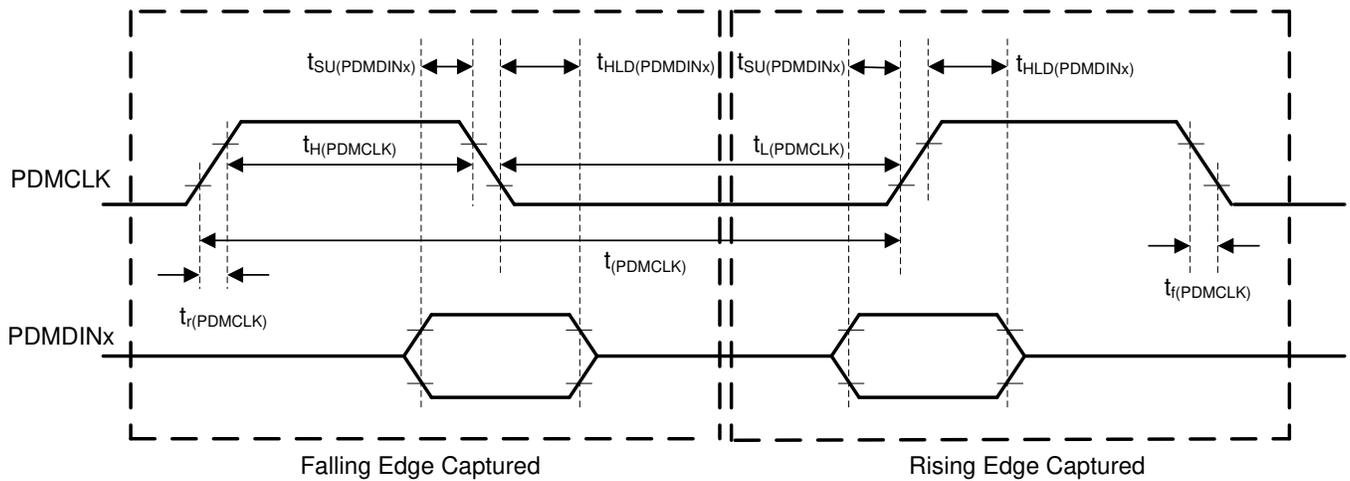
图 5-4. PDM 数字麦克风接口时序图
