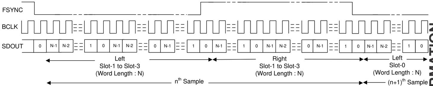
图 6-7. I<sup>2</sup>S 协议时序 (无空闲 BCLK 周期, TX\_OFFSET = 0)
