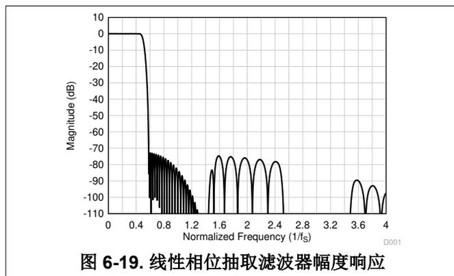
图 6-19. 线性相位抽取滤波器幅度响应
