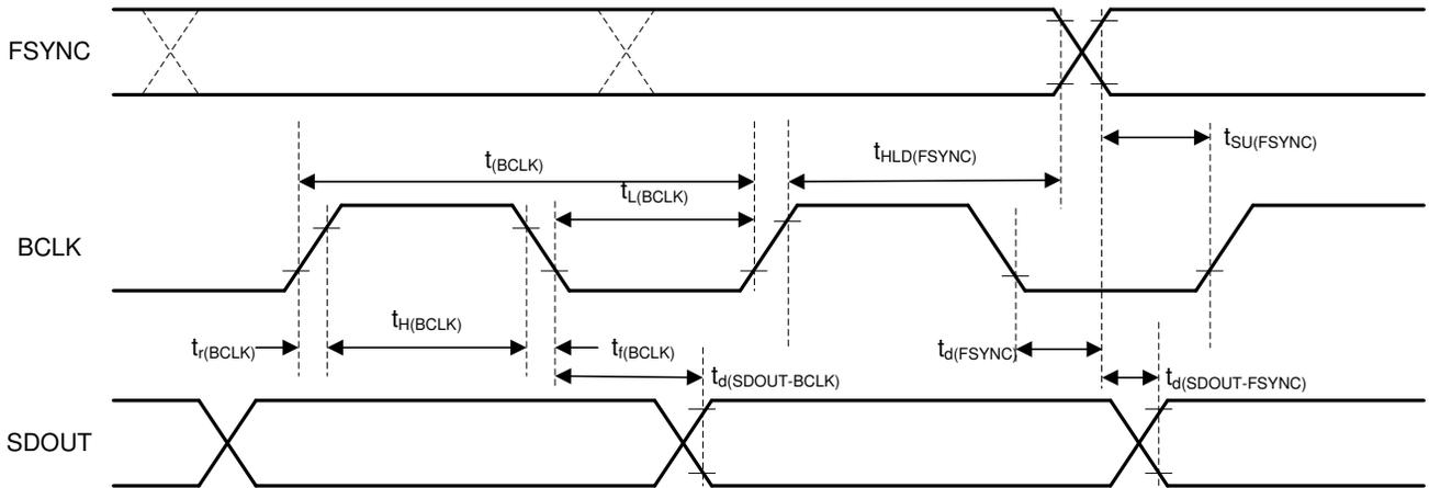
图 5-3. TDM (其中 BCLK\_POL = 1)、I<sup>2</sup>S 和 LJ 接口时序图
