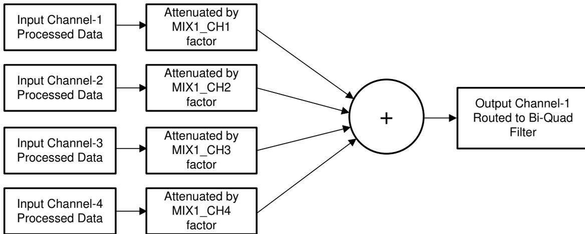
图 6-18. 可编程数字混频器方框图
