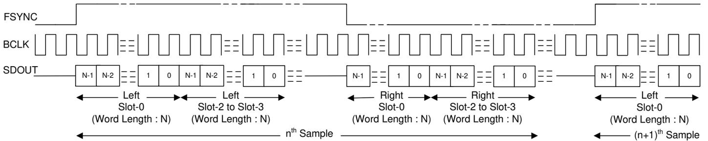
图 6-9. LJ 模式标准协议时序 (TX\_OFFSET = 0)
