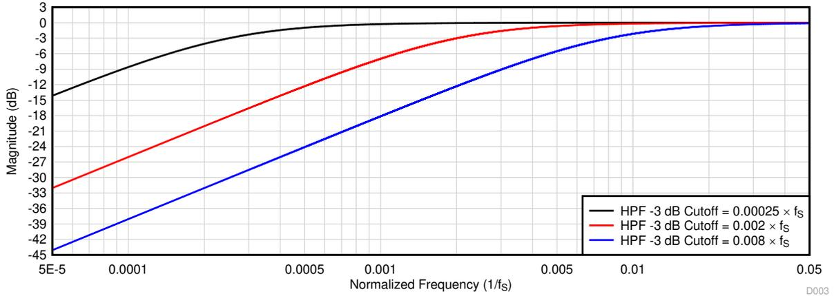
图 6-17. HPF 滤波器频率响应图
