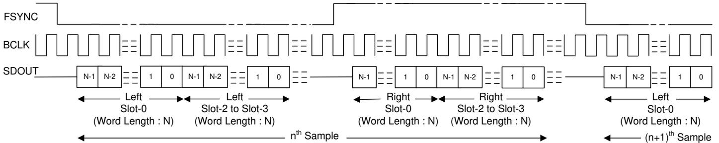
图 6-5. I<sup>2</sup>S 模式标准协议时序 (TX\_OFFSET = 0)
