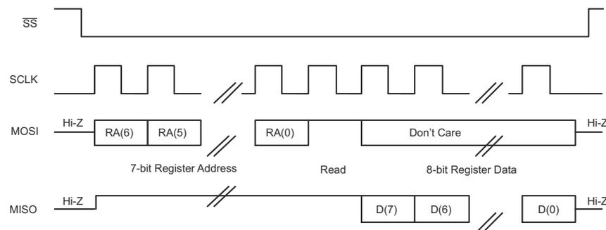
图 6-72. SPI 单字节读取传输
