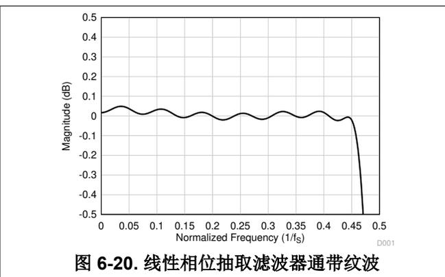
图 6-20. 线性相位抽取滤波器通带纹波
