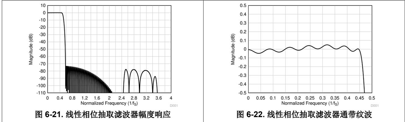
图 6-21. 线性相位抽取滤波器幅度响应
