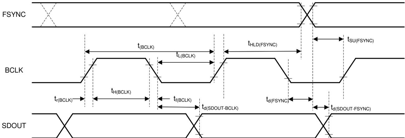
图 5-2. TDM (其中 BCLK\_POL = 1)、I<sup>2</sup>S 和 LJ 接口时序图
