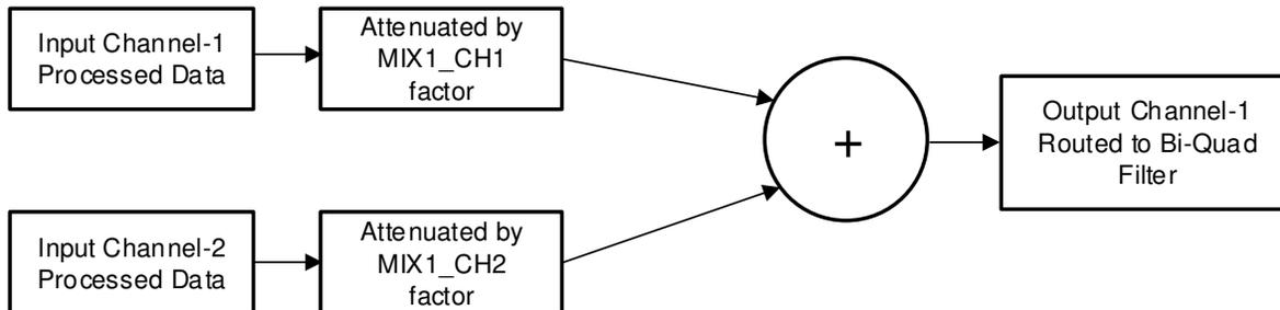
图 6-18. 可编程数字混频器方框图
