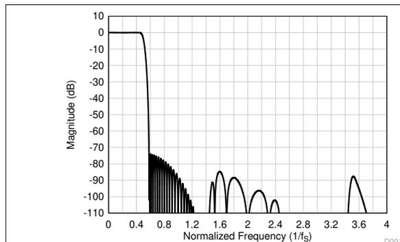
图 6-27. 线性相位抽取滤波器幅度响应
