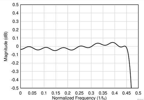
图 6-26. 线性相位抽取滤波器通带纹波
