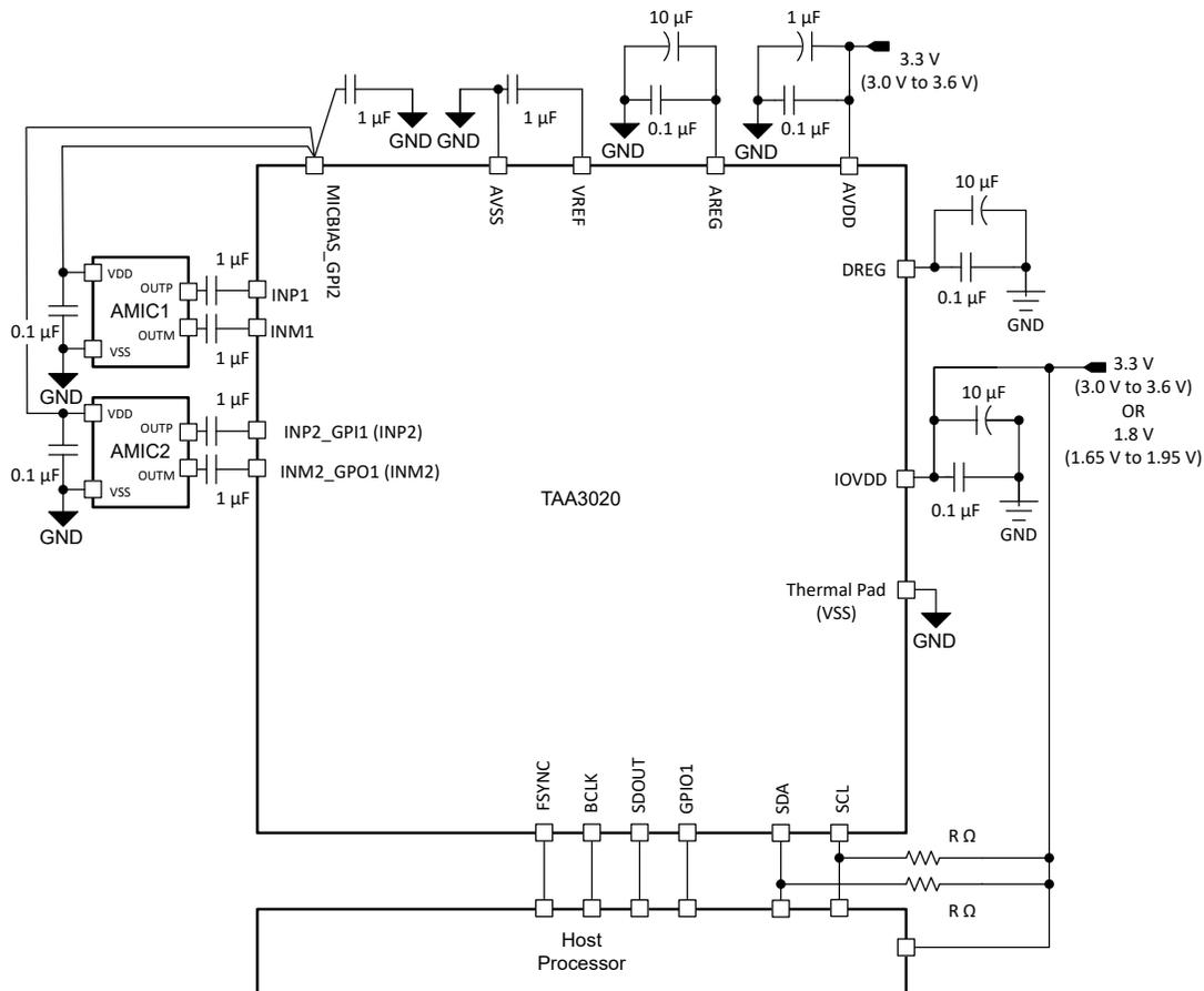
图 8-1. 双通道模拟麦克风录音图
