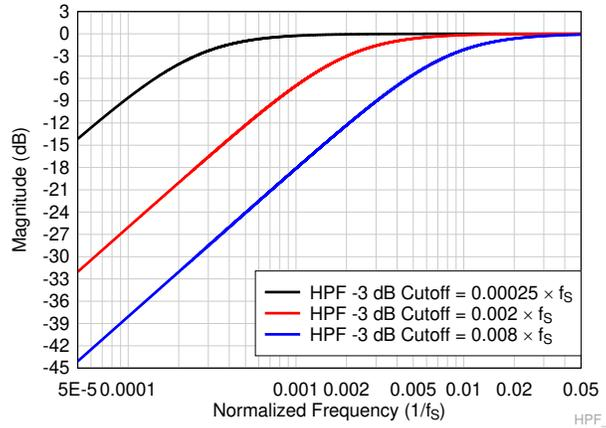
图 6-17. HPF 滤波器频率响应图
