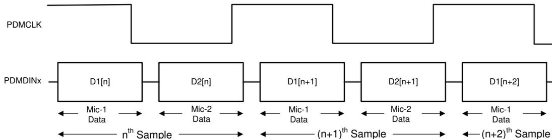
图 6-65. 数字 PDM 麦克风协议时序图
