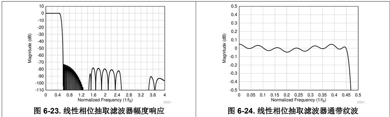
图 6-23. 线性相位抽取滤波器幅度响应
