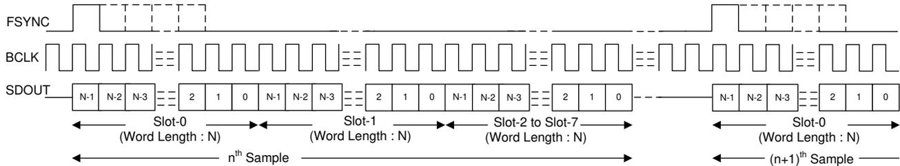
**图 6-1. TDM 模式标准协议时序 (TX\_OFFSET = 0)**
