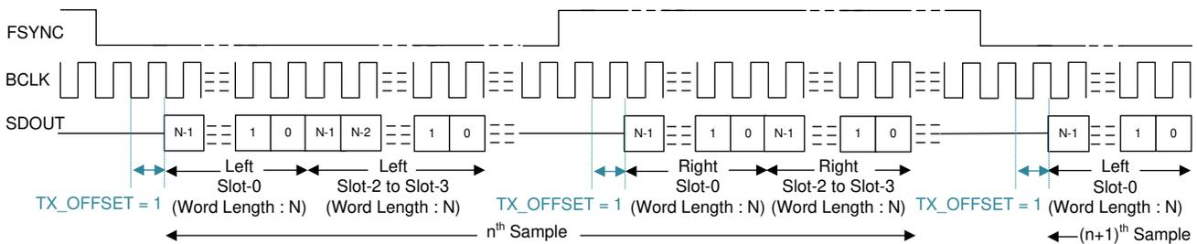
图 6-6. I<sup>2</sup>S 协议时序 (TX\_OFFSET = 1)
