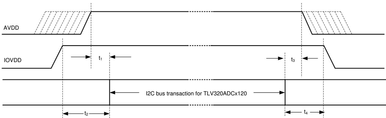
图 8-3. 电源时序要求时序图
