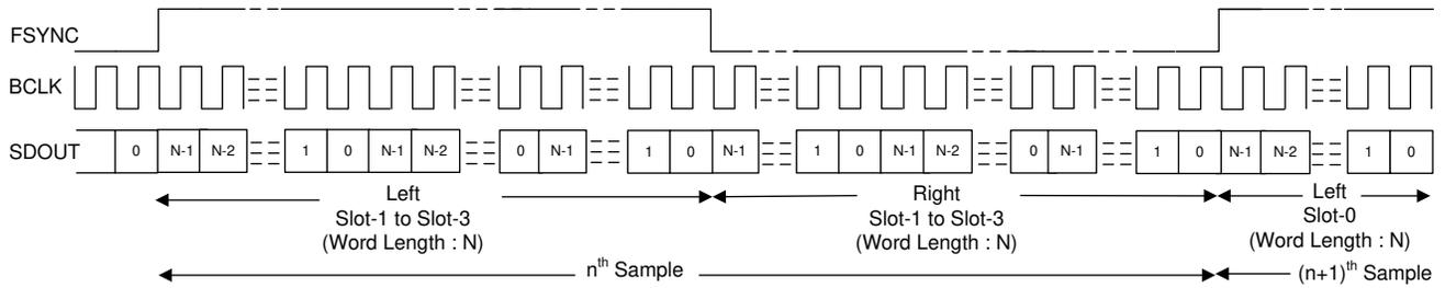
图 6-11. LJ 协议时序 (无空闲 BCLK 周期, TX\_OFFSET = 0)
