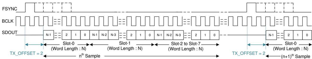
**图 6-2. TDM 模式协议时序 (TX\_OFFSET = 2)**
