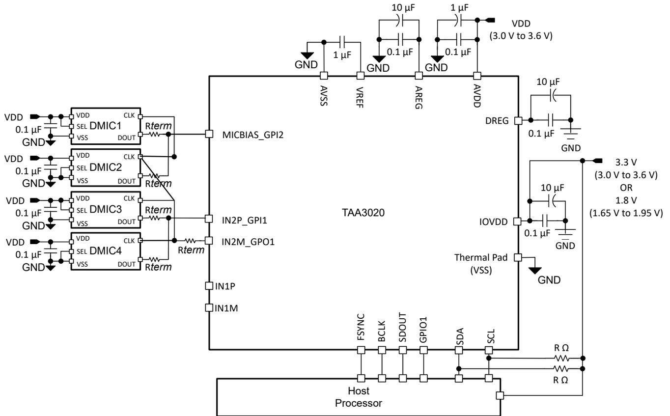
图 8-2. 四通道数字 PDM 麦克风录音图
