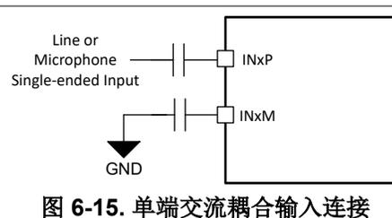
借助该器件，可以根据输入源阻抗灵活地从 2.5kΩ（默认）、10kΩ 和 20kΩ 中选择 INxP 或 INxM 上的典型输入阻抗。当输入阻抗较高时，对应的噪声会稍高或动态范围较低。[表 6-9](#)列出了录音通道输入阻抗的配置寄存器设置。
