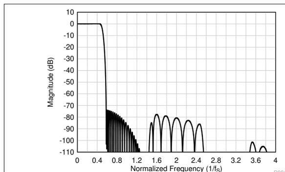
图 6-25. 线性相位抽取滤波器幅度响应
