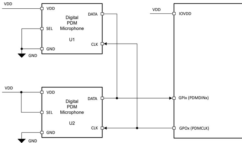
图 6-64. TAA3020 的数字 PDM 麦克风连接图
