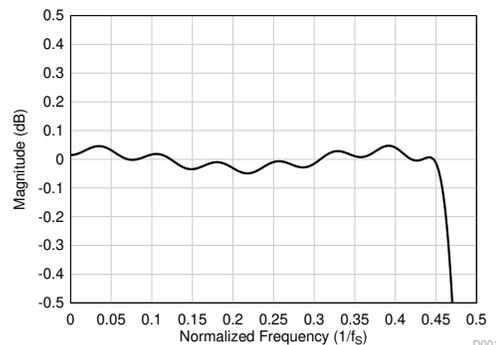
图 6-28. 线性相位抽取滤波器通带纹波
