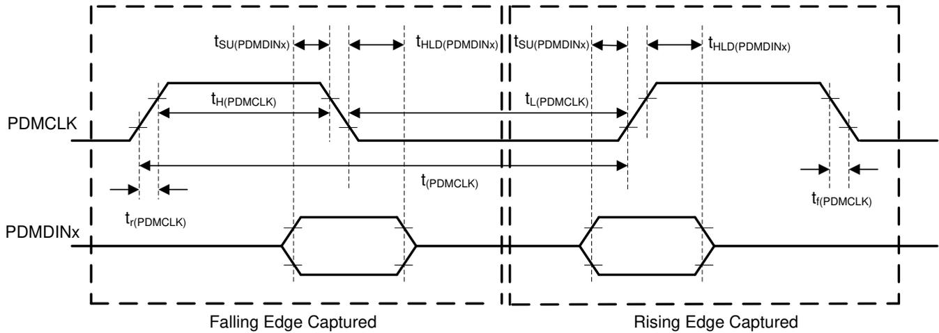
图 5-3. PDM 数字麦克风接口时序图
