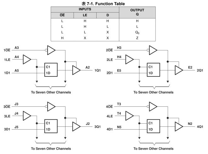
图 7-3. Logic Diagram (Positive Logic)
