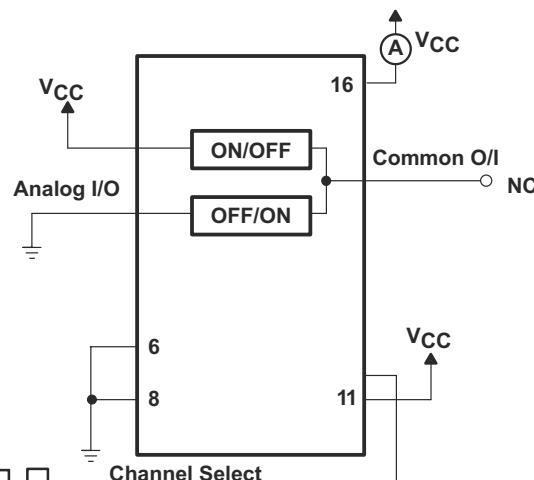
图 6-11. Power-Dissipation Capacitance Test Setup
