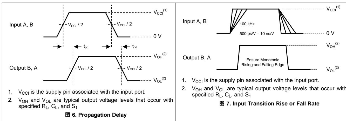
图 6. Propagation Delay
