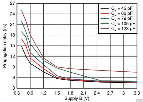
$T_A = 25^\circ\text{C}$   $V_{CCA} = 3.3\text{V}$
