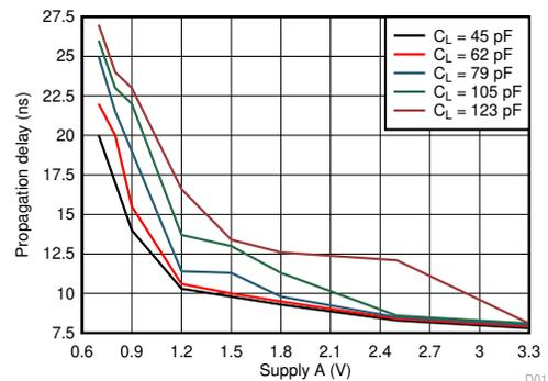
$T_A = 25^\circ\text{C}$   $V_{CCA} = 1.2\text{V}$
