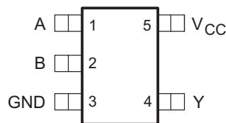
图 4-2. DCK Package 5-Pin SC70 Top View
