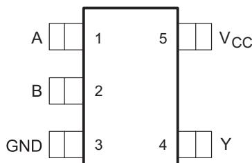
图 4-1. DBV Package 5-Pin SOT-23 Top View
