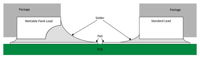
图 7-1. 焊接后具有可润湿侧翼的 QFN 封装和标准 QFN 封装的简化剖面图
