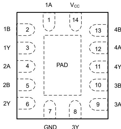
图 3-2. BQA Package, 14-Pin WQFN (Top View)
