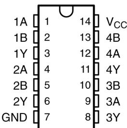
图 3-1. D or PW Package, 14-Pin SOIC or TSSOP
