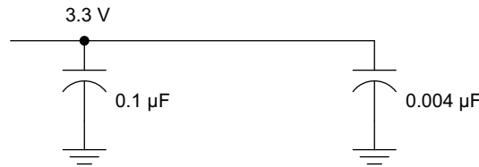
图 9-2. 建议的 M-LVDS 旁路电容器布局
