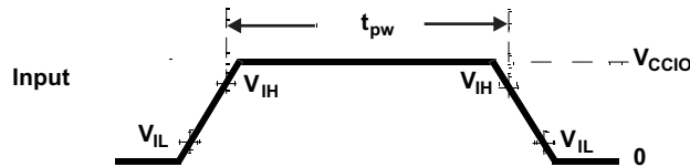
图 4-2. TTL - 电平输入
