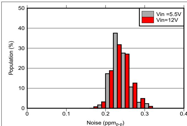
图 7-19. 0.1-Hz to 10-Hz Voltage Noise Distribution (300 units)
