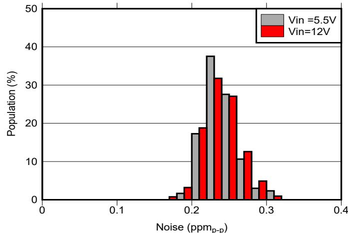
**图 8-10. 0.1-Hz to 10-Hz Voltage Noise Distribution**
