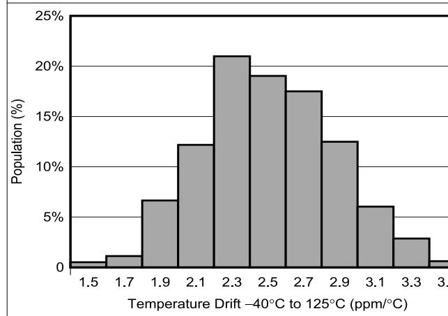
图 7-5. Temperature Drift Distribution (REF7012QDGKR)
