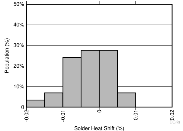
图 8-22. 焊接热漂移分布 - DGK 封装
