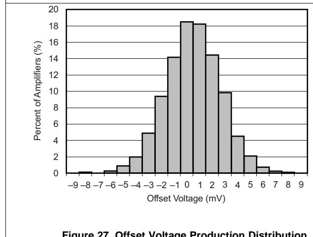
Figure 27. Offset Voltage Production Distribution
