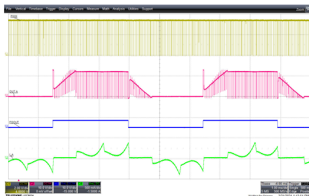
图 9-12. 带 FGOUT 的驱动器 PWM 运行
