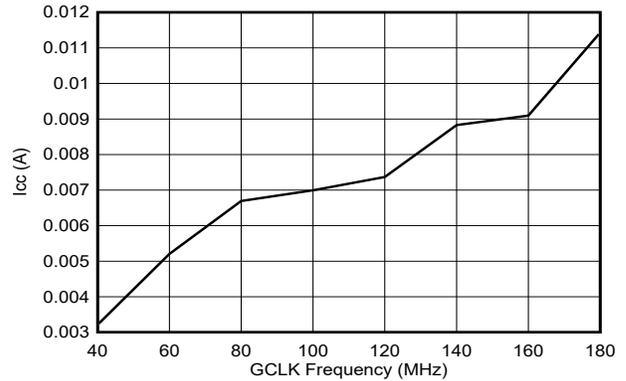
图 5-7. Icc 电流与 GCLK 频率间的关系
