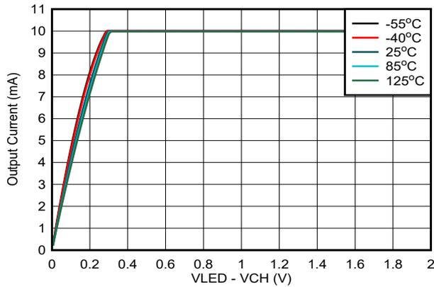
图 5-4. 通道电流与 (VLED-Vchannel) 电压间的关系
