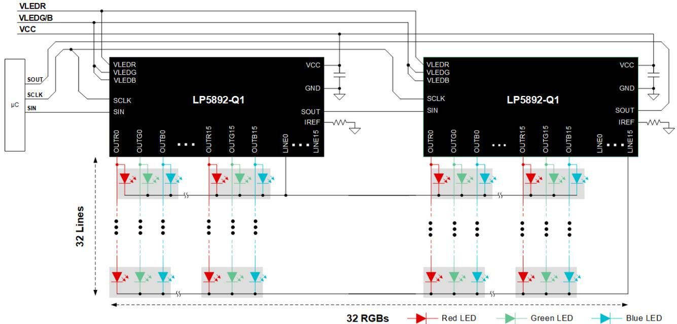
图 7-1. 具备双器件可堆叠连接的 LP5892-Q1
