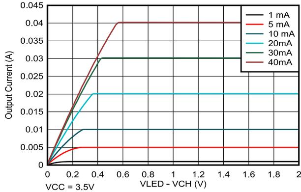
图 5-2. 通道电流与 (VLED-Vchannel) 电压间的关系
