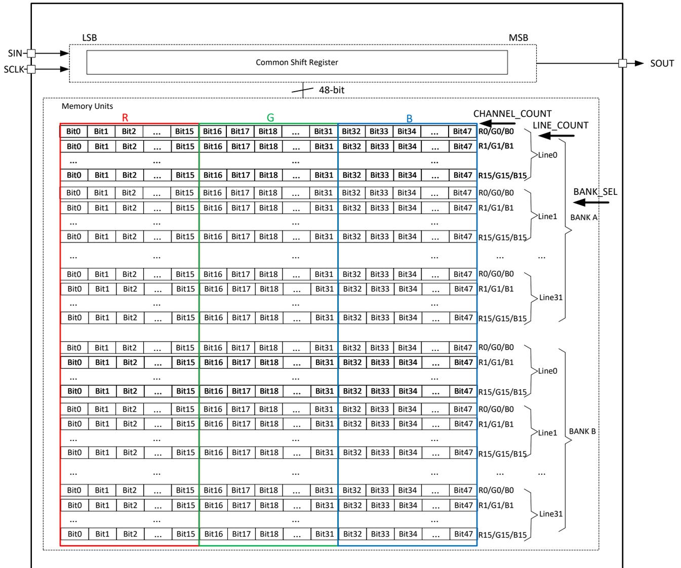
图 6-24. LP5892-Q1 存储器单元结构
