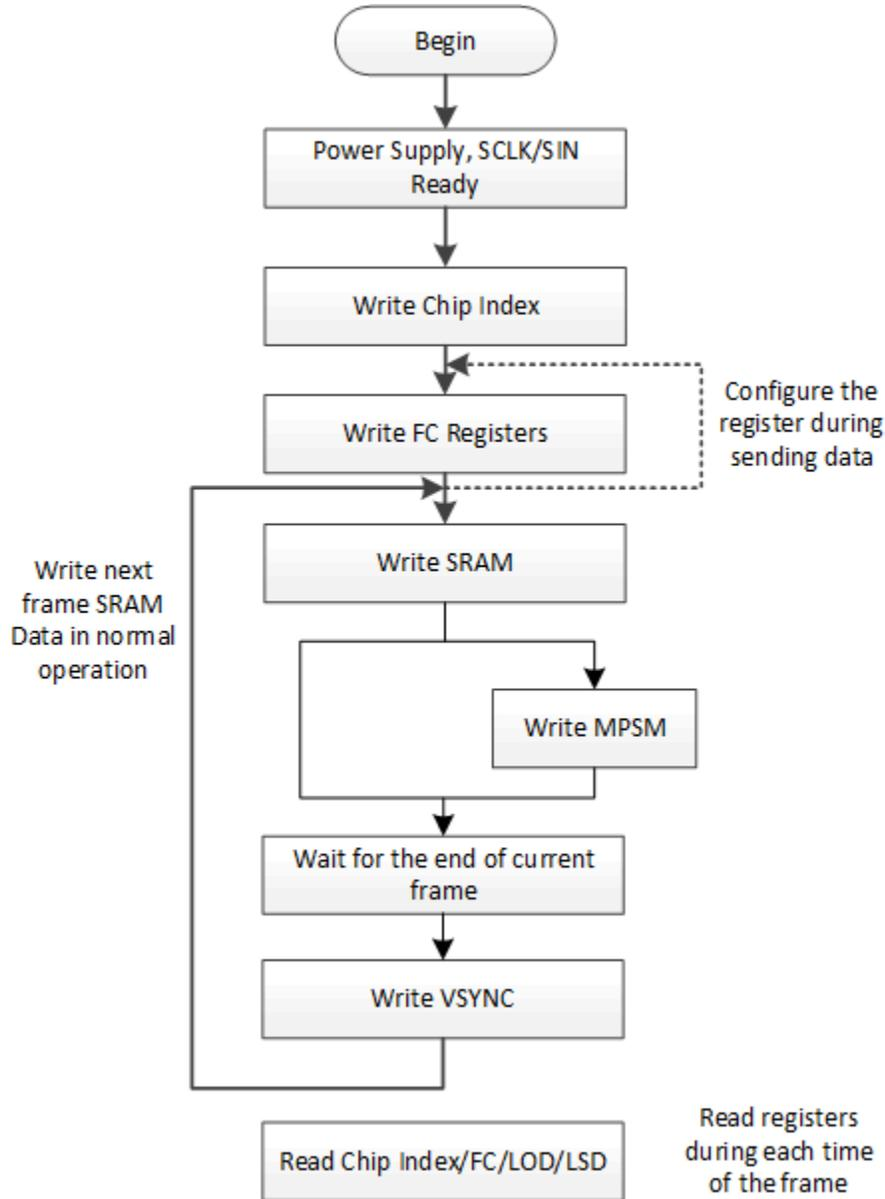
图 6-17. MPSM 命令的设计过程
