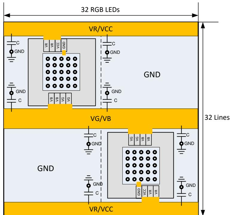
图 7-9. 电源轨布线建议
