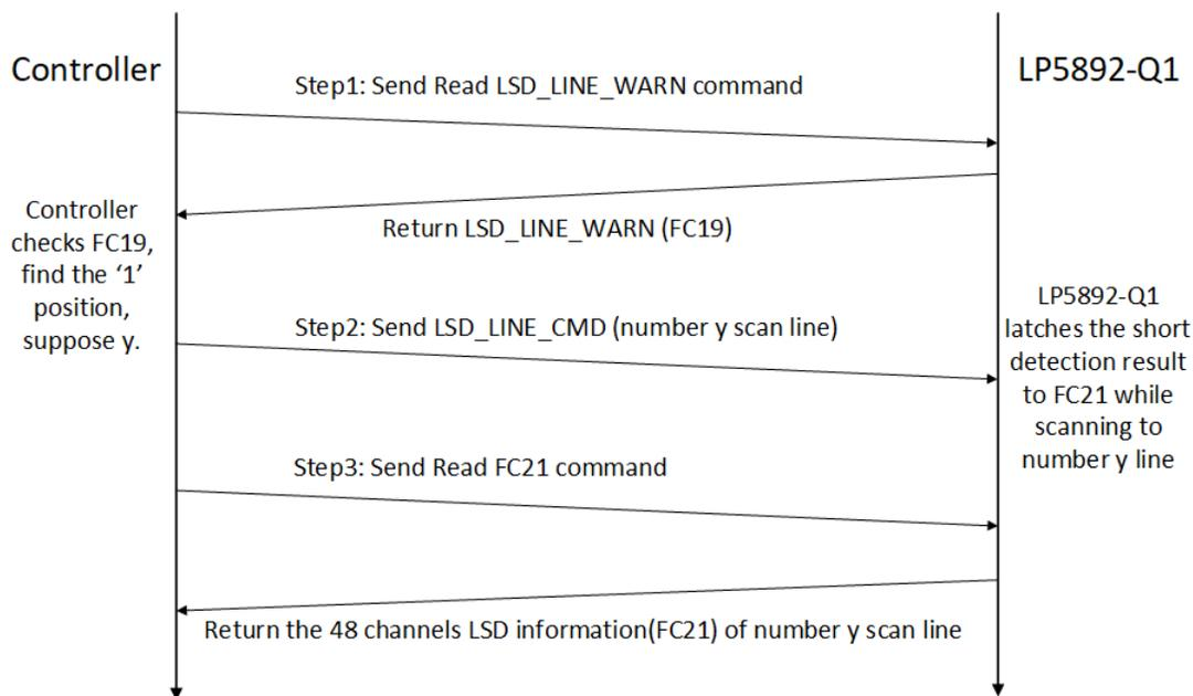
图 6-11. 读取 LED 短路信息的步骤
