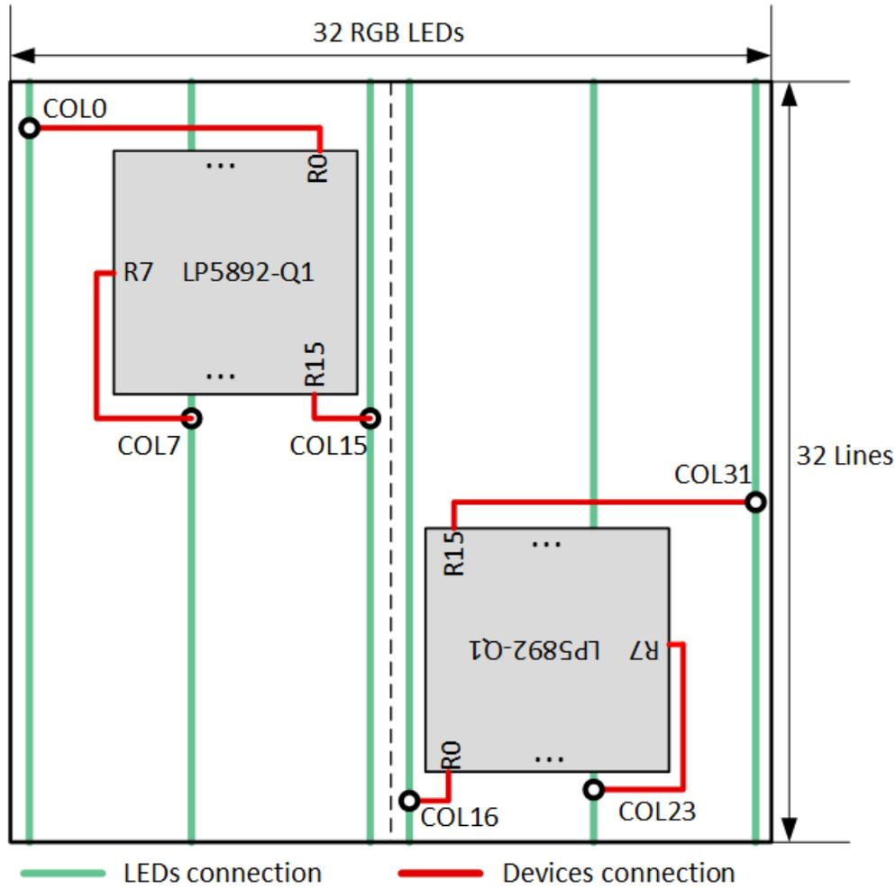
图 7-12. 使用通道顺序进行道布线的建议
