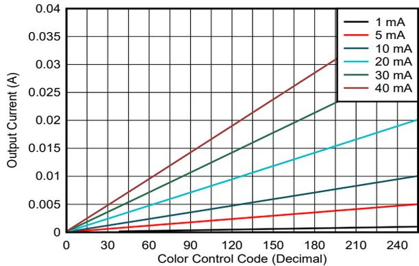
图 5-6. 颜色控制代码与输出电流间的关系
