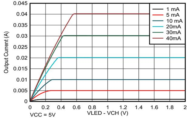
图 5-3. 通道电流与 (VLED-Vchannel) 电压间的关系
