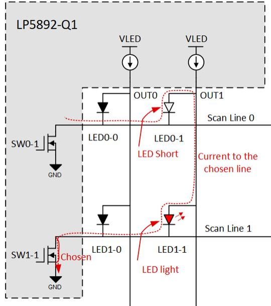
图 6-12. LED 短路毛毛虫问题
