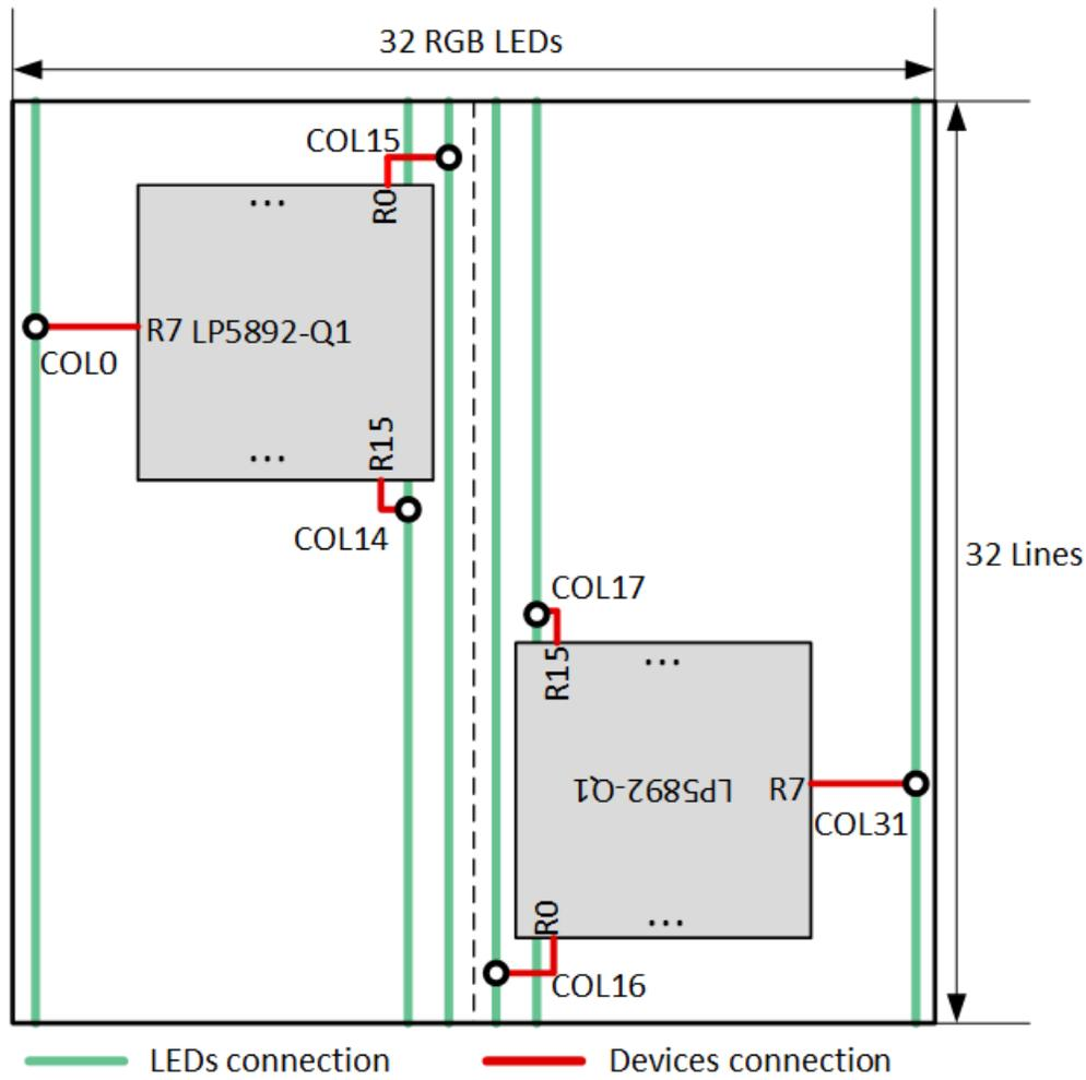
图 7-11. 使用较短导线进行通道布线的建议
