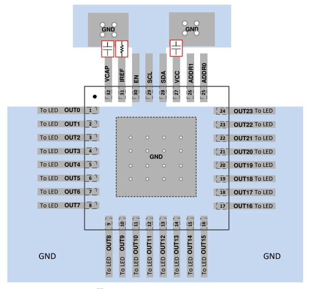
图 8-5. LP5024 VQFN Layout Example
