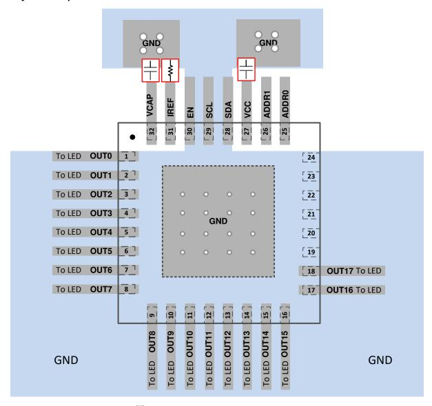
图 8-4. LP5018 VQFN Layout Example
