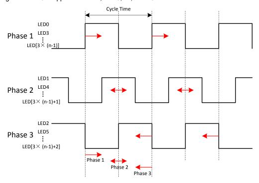
图 7-4. PWM Phase-Shifting
