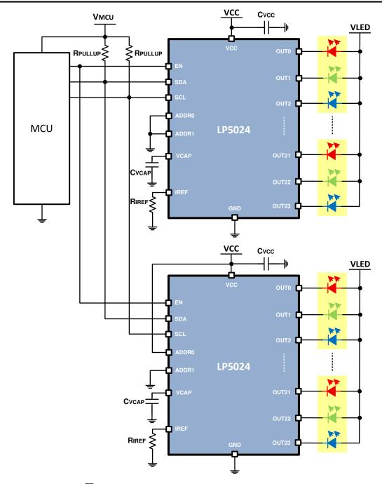
图 8-1. Driving Dual LP5024 Application Example
