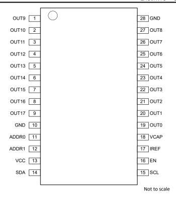
图 5-3. LP5018 DGS Package 28-pin VSSOP Top View
