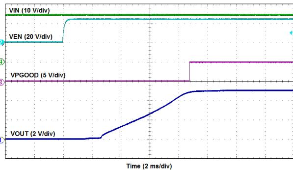
**图 7-11. Enable Turn-ON**
