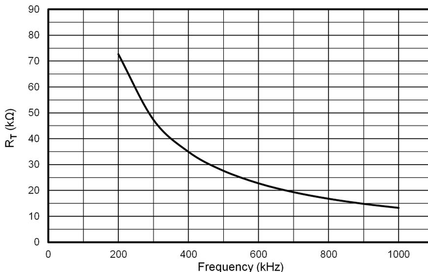
图 7-4. R<sub>T</sub> 与频率曲线间的关系表 7-1. 典型频率设置 R<sub>T</sub> 电阻
