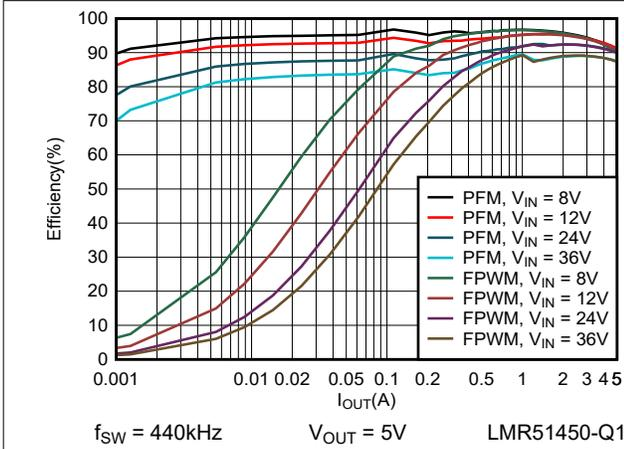
图 6-1. 5V 效率与负载电流间的关系
