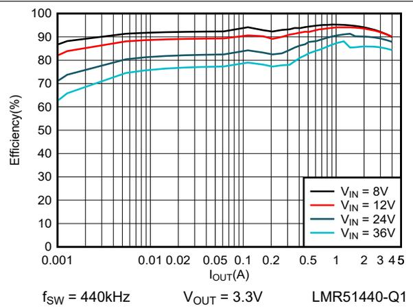
图 6-4. 3.3V 效率与负载电流间的关系
