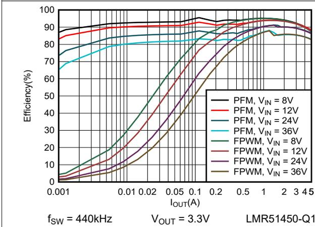
图 6-3. 3.3V 效率与负载电流间的关系
