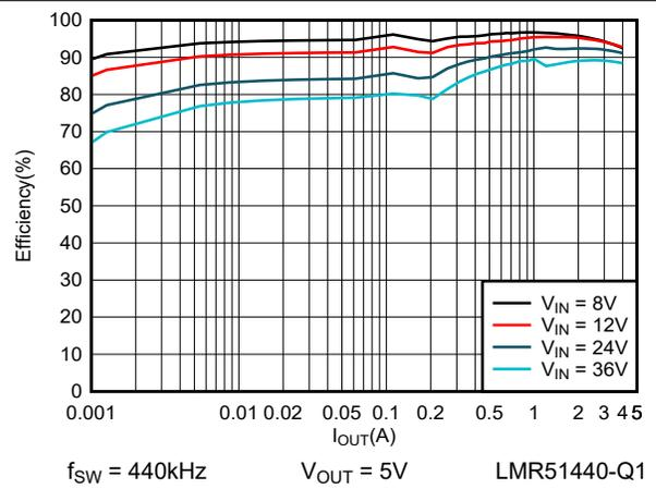
图 6-2. 5V 效率与负载电流间的关系
