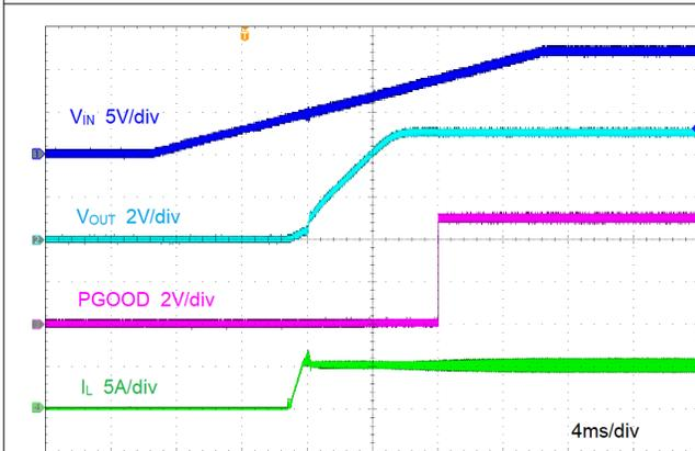
图 8-4. 由  $V_{IN}$  启动
