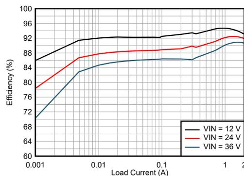
效率：V<sub>OUT</sub> = 5 V (固定值)、1 MHz
