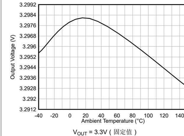
图 6-3. 输出电压精度与温度间的关系
