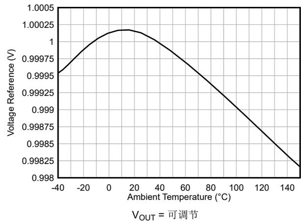
图 6-4. 反馈电压精度与温度间的关系
