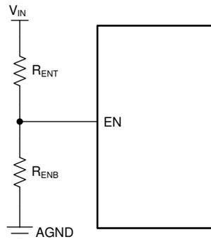
图 7-1. 使用 EN 引脚时的 VIN UVLO
