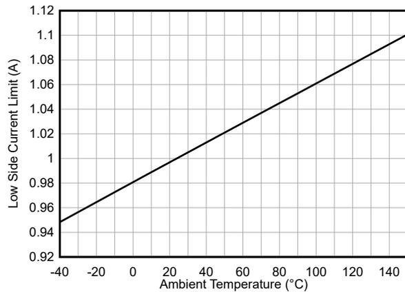
图 6-6. 低侧 MOSFET 电流限制与温度间的关系
