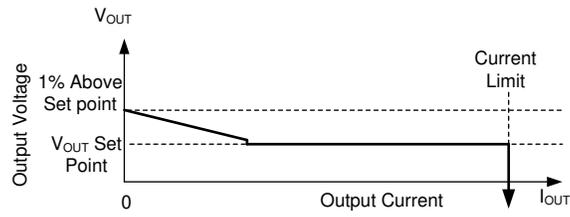
在自动模式下，一旦输出电流低于器件额定电流的大概 1/10，输出电阻就会增加，以便在降压转换器完全空载时输出电压为 1% 高电平。
