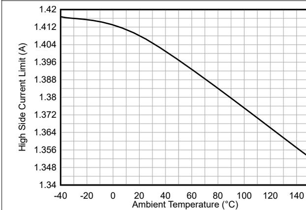
图 6-5. 高侧 MOSFET 电流限制与温度间的关系
