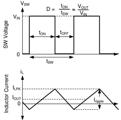
在 FPWM 模式下，即使  $I_{OUT}$  小于  $I_{ripple}$  的一半，也可实现连续导通 (CCM)。
