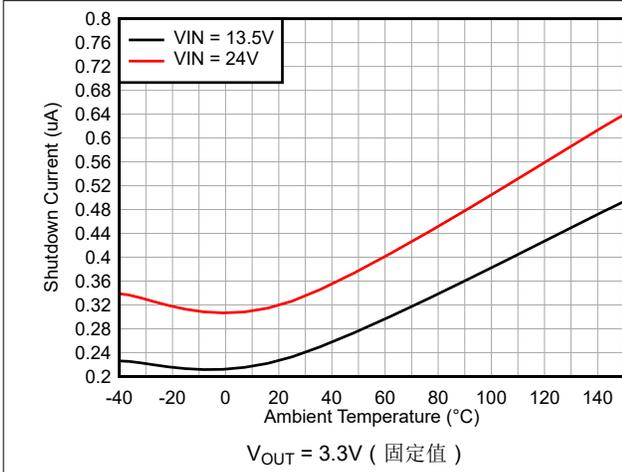
图 6-1. 关断电流与温度之间的关系
