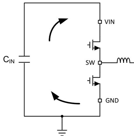
图 8-28. 具有快速边沿的电流环路
