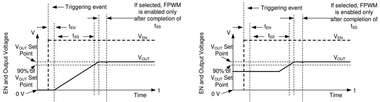
图 7-9. 带和不带预偏置电压的软启动/停止
