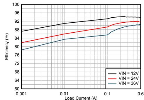
效率：V<sub>OUT</sub> = 5V (固定值)、400kHz
