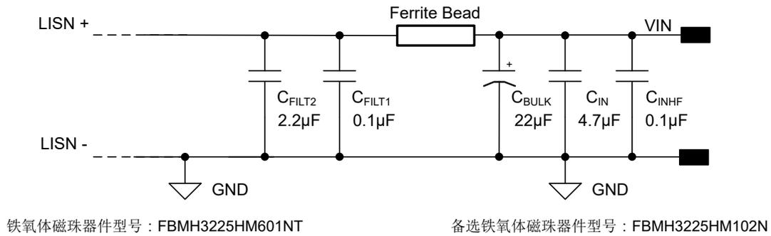
图 8-26. 典型输入 EMI 滤波器
