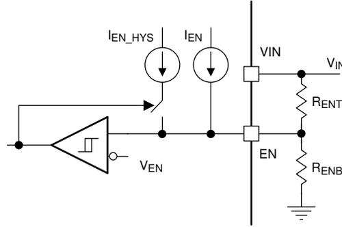
图 6-3. 由使能分压器实施的系统 UVLO
