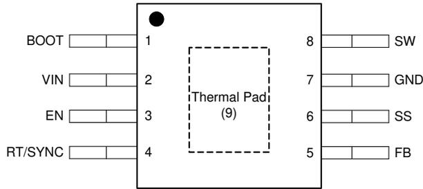
图 4-1. DDA 封装 8 引脚 (HSOIC) 顶视图
