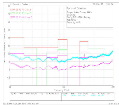
图 9-47. 传导 EMI 与 CISPR25 限值 (黄色: 峰值信号, 蓝色: 平均信号)
