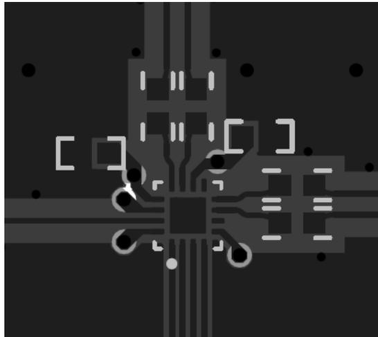
图 9-8. LMK3H0102-Q1 的 PCB 布局示例，顶层
