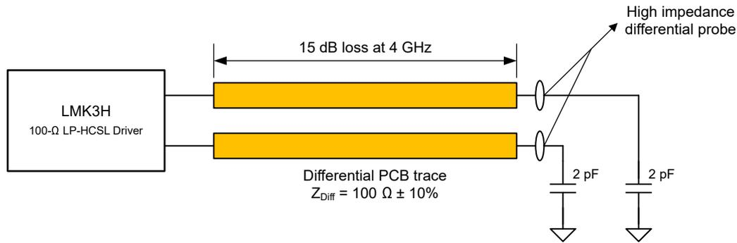
图 6-5. PCIe 器件测试期间的 LP-HCSL 输出配置
