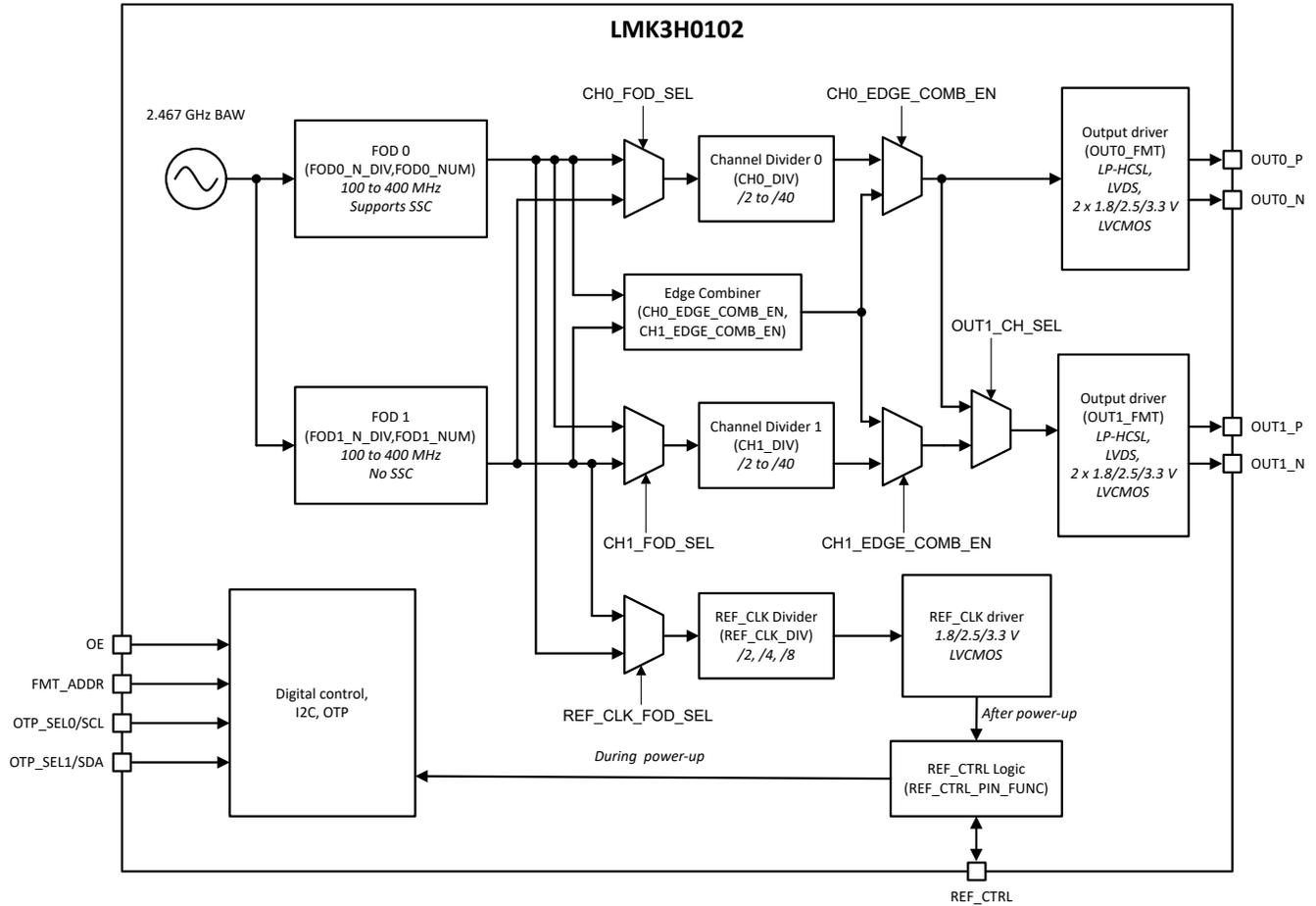
图 7-1. LMK3H0102-Q1 功能方框图
