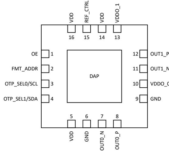
图 4-1. LMK3H0102-Q1 16 引脚 VQFN 顶视图
