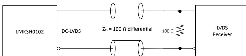
图 7-7. 将 LMK3H0102-Q1 LVC MOS 输出与直流 LVDS 接收器相连接
