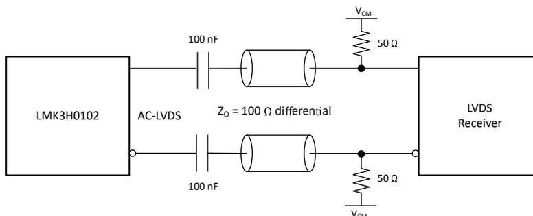
图 7-6. 将 LMK3H0102-Q1 LVC MOS 输出与交流 LVDS 接收器相连接
