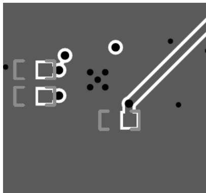
图 9-9. LMK3H0102-Q1 的 PCB 布局示例，底层
