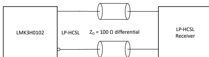
图 7-8. 将 LMK3H0102-Q1 LVC MOS 输出与 LP-HCSL 接收器相连接
