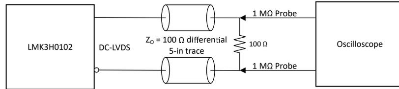
图 6-3. 器件测试期间的直流 LVDS 输出配置
