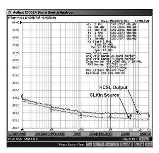
图 9-7. HCSL Phase Noise at 100 MHz
