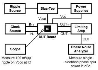
图 10-1. PSRR Test Setup
