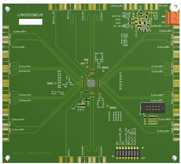
图 11-1. LMK00334-Q1 Layout Example
