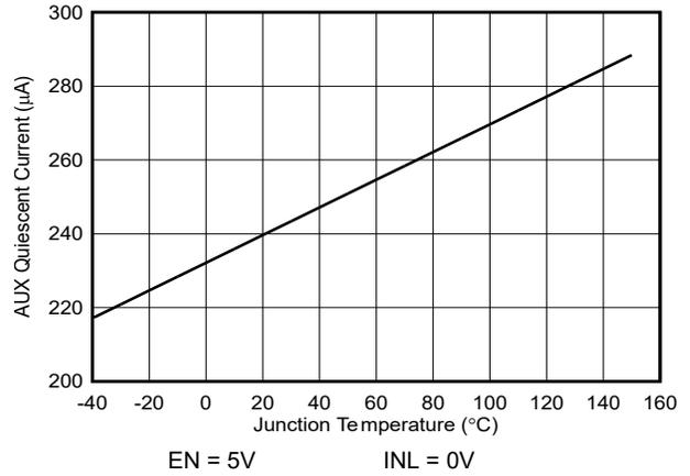
图 5-14. AUX 静态电流与结温间的关系
