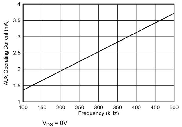
图 5-16. AUX 工作电流与频率间的关系
