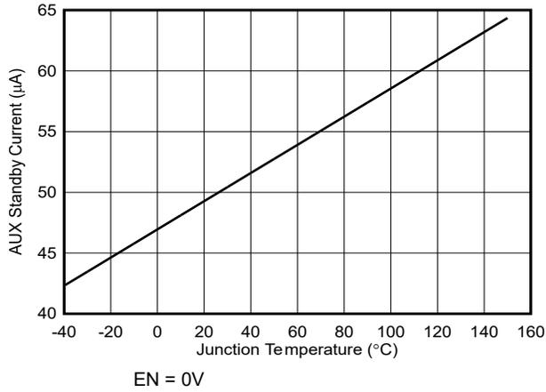
图 5-13. AUX 待机电流与结温间的关系
