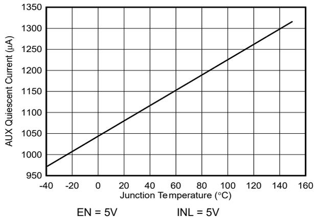
图 5-15. AUX 静态电流与结温间的关系
