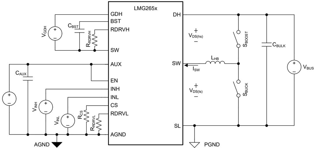
图 6-1. GaN 功率 FET 开关参数测试电路
