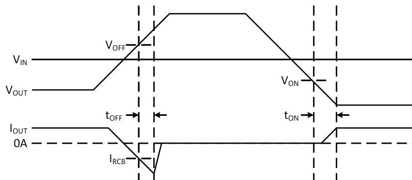
**图 14. RCB Waveforms**
