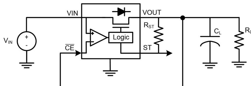
**图 13. RCB Circuit**
