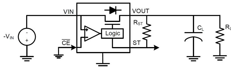
**图 12. RPP Protection Circuit**
