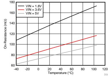
$V_{\text{CE}} < V_{\text{IN}}$        $I_{\text{OUT}} = 200\text{mA}$
