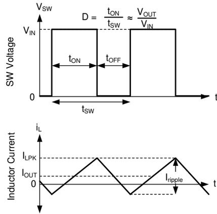
即使  $I_{OUT}$  小于  $I_{ripple}$  的一半，也可以实现 FPWM 模式连续导通 (CCM)。
