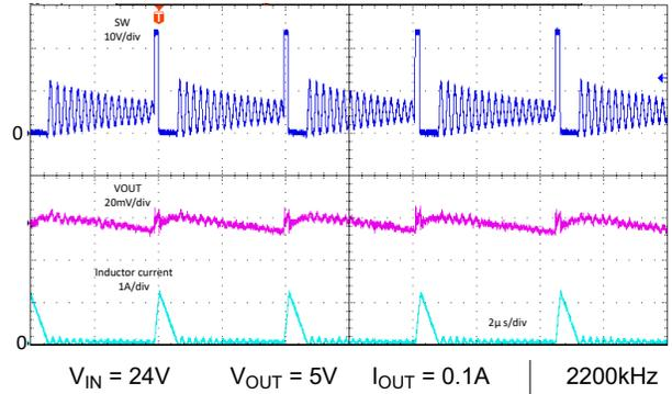
图 8-62. 典型开关波形 - LM6x625 - 自动
