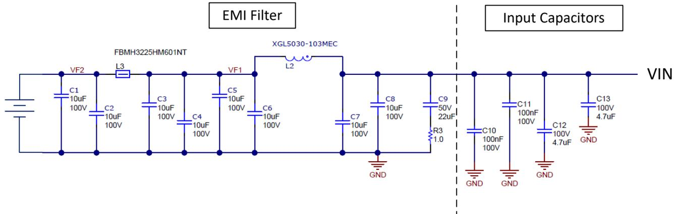
图 8-76. 适用于 400kHz 的 EMI 输入滤波器
