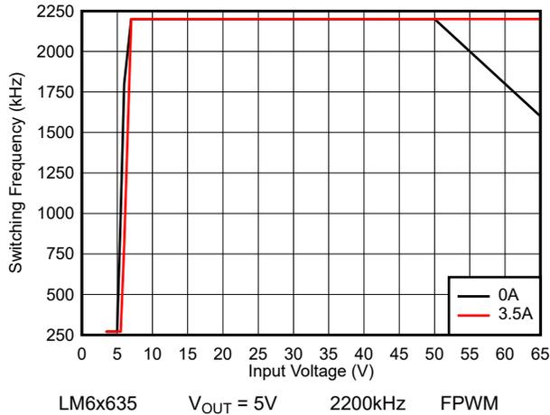
图 8-37. LM6x635 开关频率与输入电压间的关系
