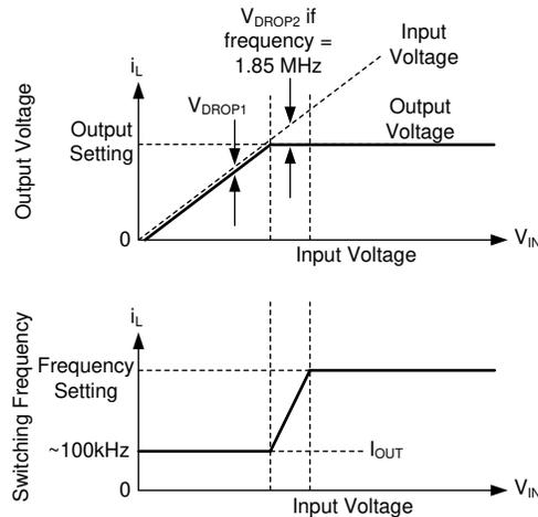
输出电压和频率与输入电压间的关系：如果输入电压和输出电压设置之间几乎没有差异，IC 会降低频率以保持稳压。如果输入电压过低，无法在大约  $110kHz$  的频率下提供所需的输出电压，则输出电压会跟踪输入电压。
