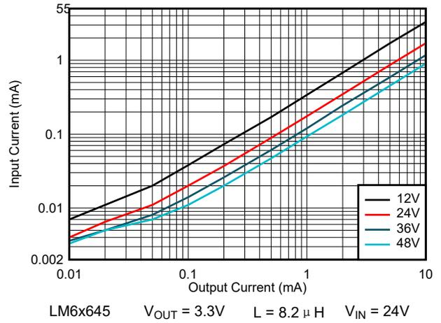
图 8-46. 输入电源电流 - 自动模式
