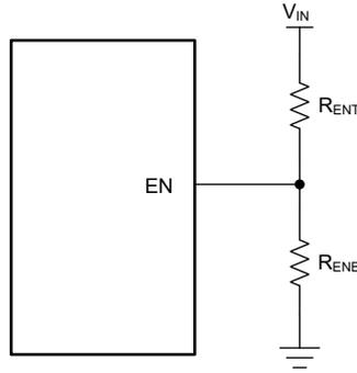
图 7-2. 使用 EN 引脚时的 VIN UVLO
