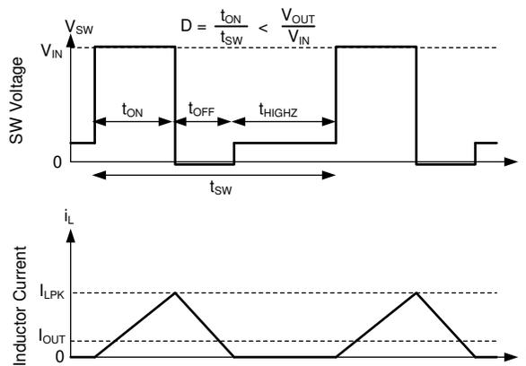
在自动模式下，在电感器电流接近零之后，低侧器件会关闭。因此，在输出电流小于 CCM 模式中电感器纹波的一半之后，该器件会以 DCM 模式运行。这相当于说正在运行二极管仿真。
