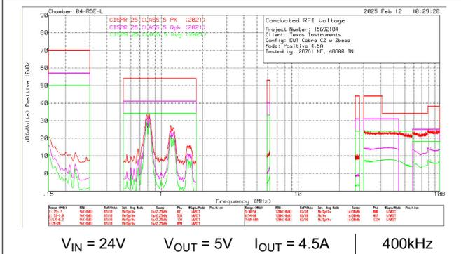
图 8-57. LM6x645 传导 EMI - 正向线路
