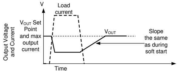
无论是由于高负载还是低输入电压导致输出电压下降，一旦导致输出降至设定点以下的条件消除，输出就会以与启动期间相同的速度爬升。尽管不会由于压降而触发断续，但如果在恢复期间输出电压低于输出设定点的 0.4 倍且持续时间超过 64 个时钟周期，则原则上可以在恢复期间触发断续。
