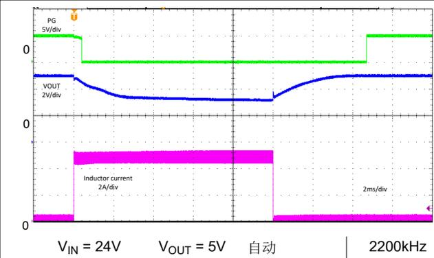
图 8-70. 电流限值瞬态
