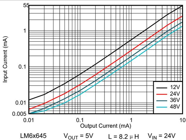
图 8-47. 输入电源电流 - 自动模式
