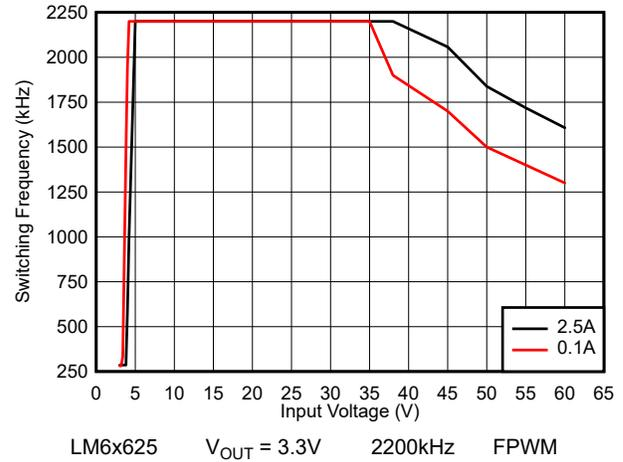
图 8-34. LM6x625 开关频率与输入电压间的关系
