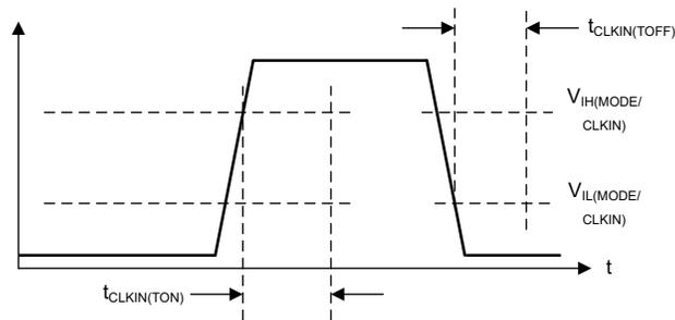
该图显示了检测同步信号所需的条件。
