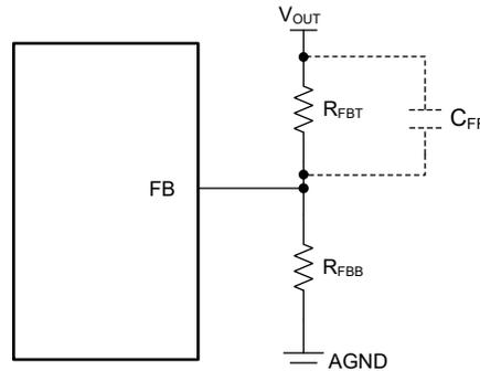
图 7-1. 设置可调版本的输出电压
