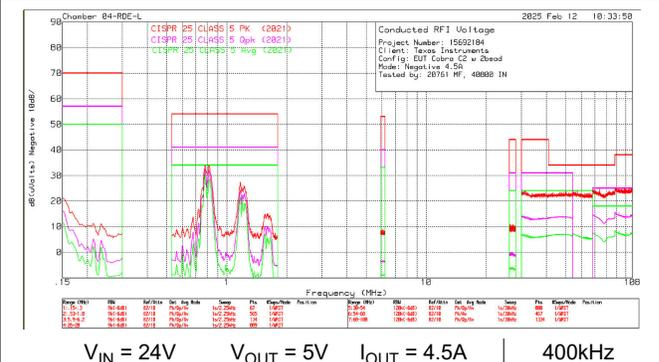
图 8-58. LM6x645 传导 EMI - 负向线路
