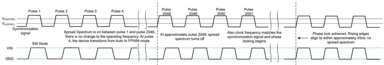
在第 4 个脉冲上，检测到同步信号。在大约 2048 个脉冲之后，同步信号准备好进行同步，并使用无干扰技术调整频率，然后相位被锁定。
