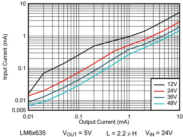
图 8-45. 输入电源电流 - 自动模式
