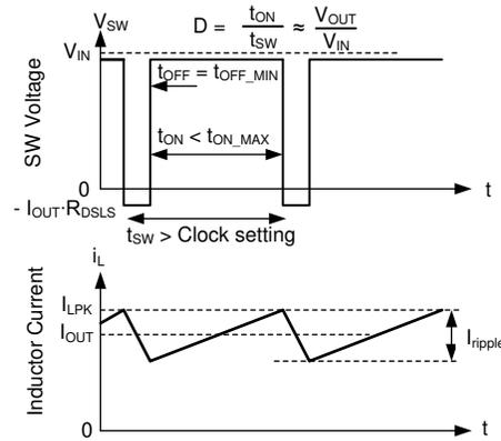
该图显示了压降时的开关波形。电感器电流需要比正常时钟更长的时间才能达到所需的峰值。因此，频率会下降。该频率下降受到  $t_{ON\_MAX}$  的限制。
