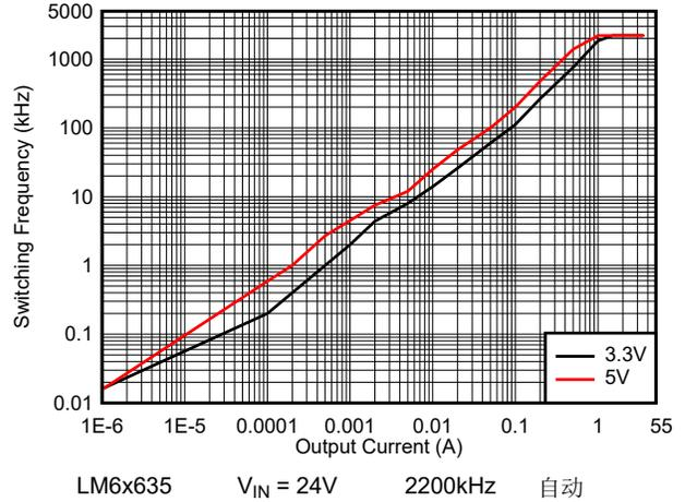
图 8-32. LM6x635 开关频率与负载电流间的关系
