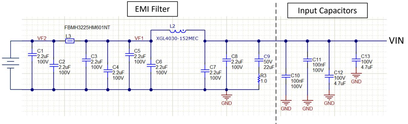
图 8-75. 适用于 2200kHz 的 EMI 输入滤波器
