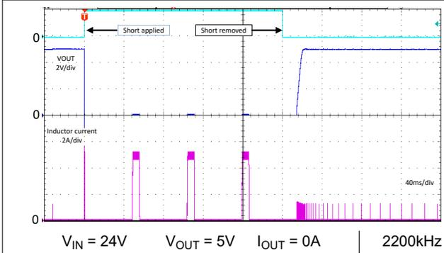
图 8-69. 输出短路电路和恢复 - 自动
