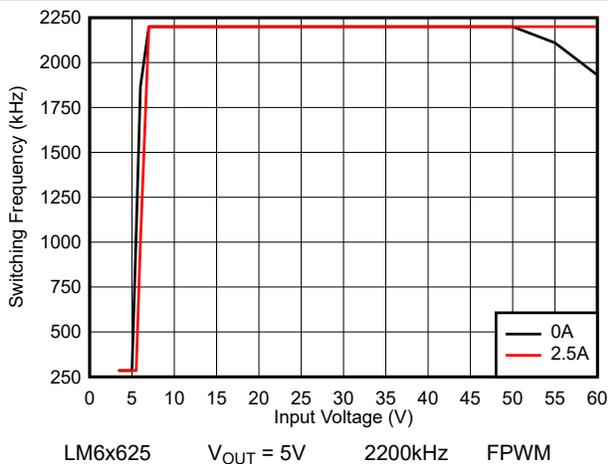
图 8-35. LM6x625 开关频率与输入电压间的关系
