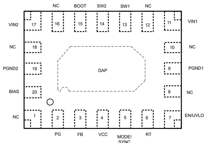
图 5-1. 20 引脚 RZT、WQFN 封装 (顶视图)
