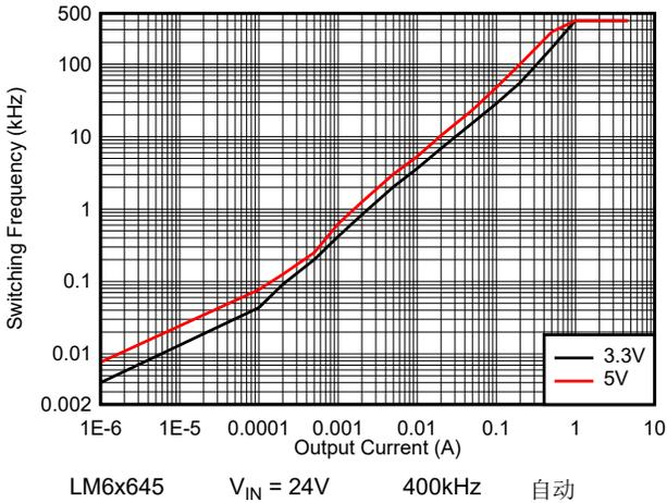
图 8-33. LM6x645 开关频率与负载电流间的关系
