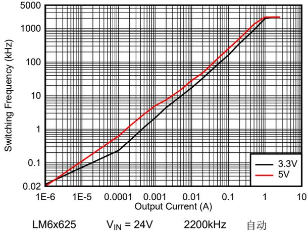
图 8-31. LM6x625 开关频率与负载电流间的关系
