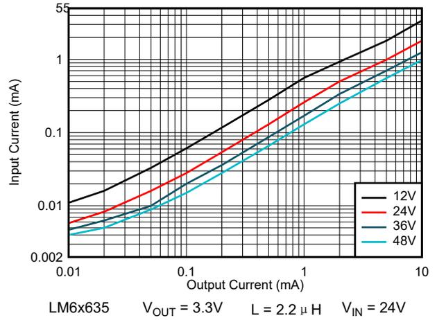
图 8-44. 输入电源电流 - 自动模式
