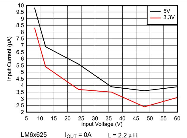
图 8-48. 空载输入电源电流 - 自动模式
