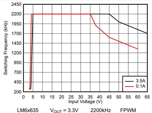
图 8-36. LM6x635 开关频率与输入电压间的关系
