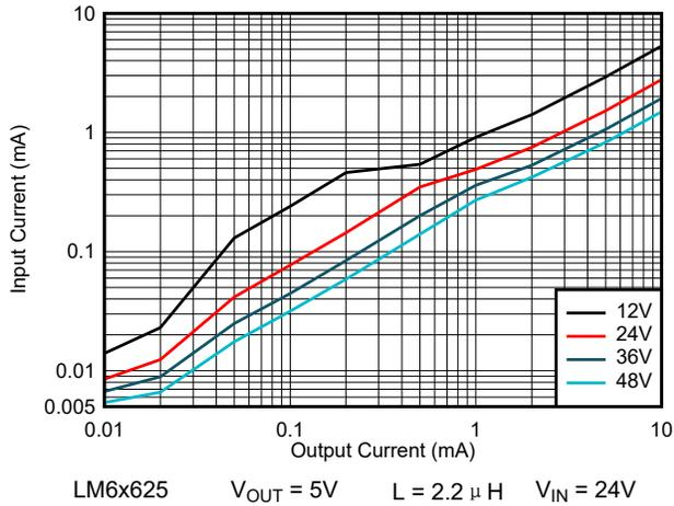
图 8-43. 输入电源电流 - 自动模式
