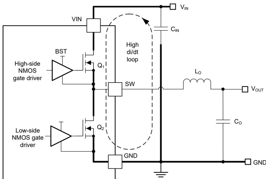
图 8-77. 具有快速边沿的电流环路
