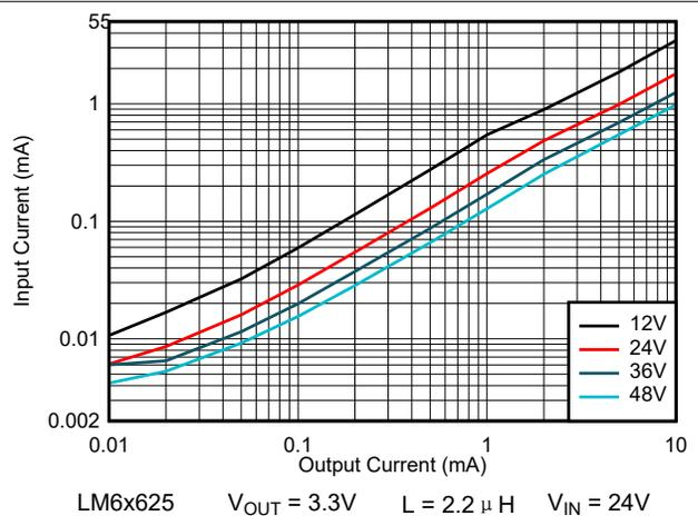
图 8-42. 输入电源电流 - 自动模式
