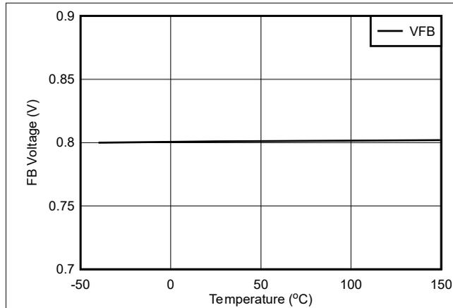
图 6-1. 反馈电压
