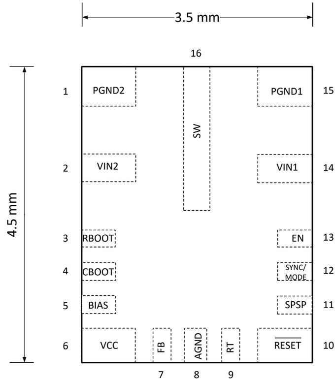
图 6-1. 16-Pin VQFN RPH Package (Top View)
