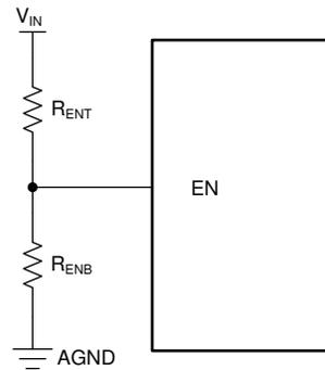
图 8-2. VIN UVLO Using the EN Pin
