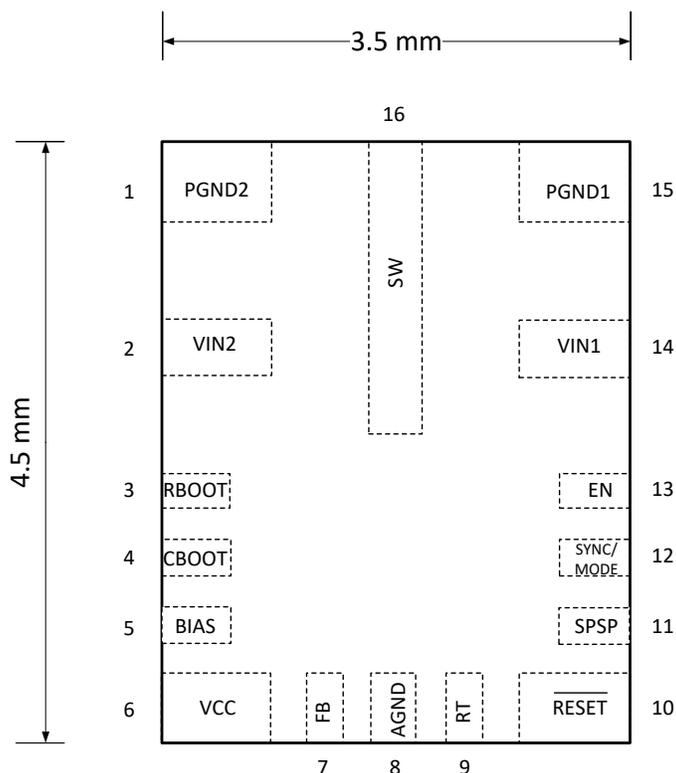
图 6-1. 16-Pin VQFN RPH Package (Top View)
