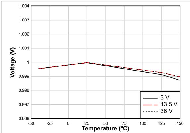
图 7-1. Feedback Voltage
