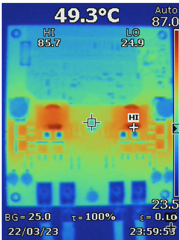
图 8-21. 热像图 : 降压模式, V_{in} = 48\text{V} , V_{OUT} = 14.5\text{V} , I_{OUT} = 60\text{A} , 对流
