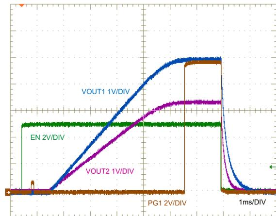
图 8-8. 使能端开启和关闭特性
