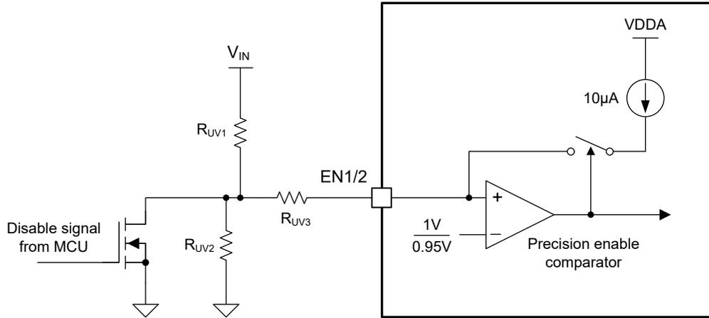
图 7-2. 可编程输入电压 UVLO 导通/关断
