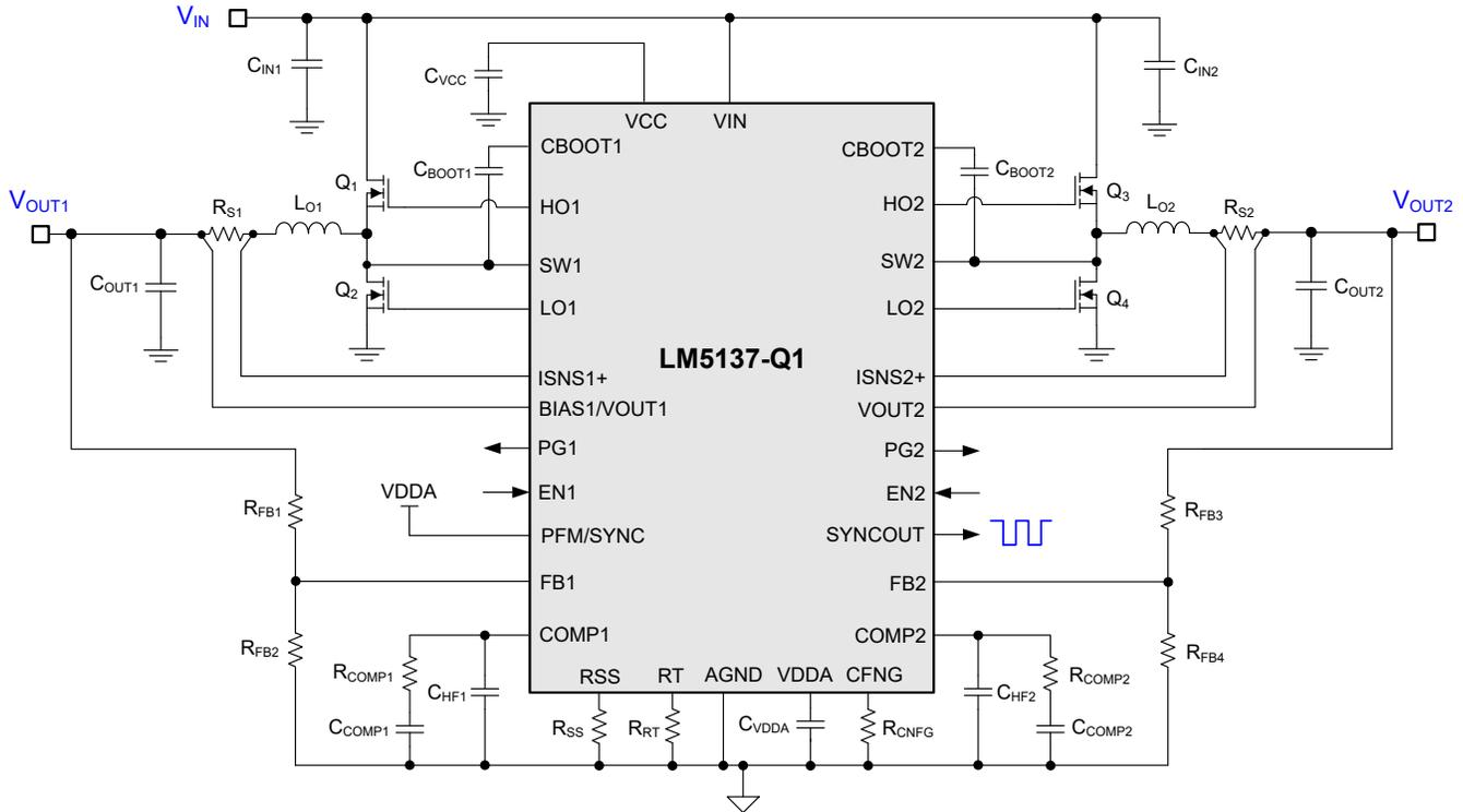
图 7-1. LM5137-Q1 双路输出稳压器原理图
