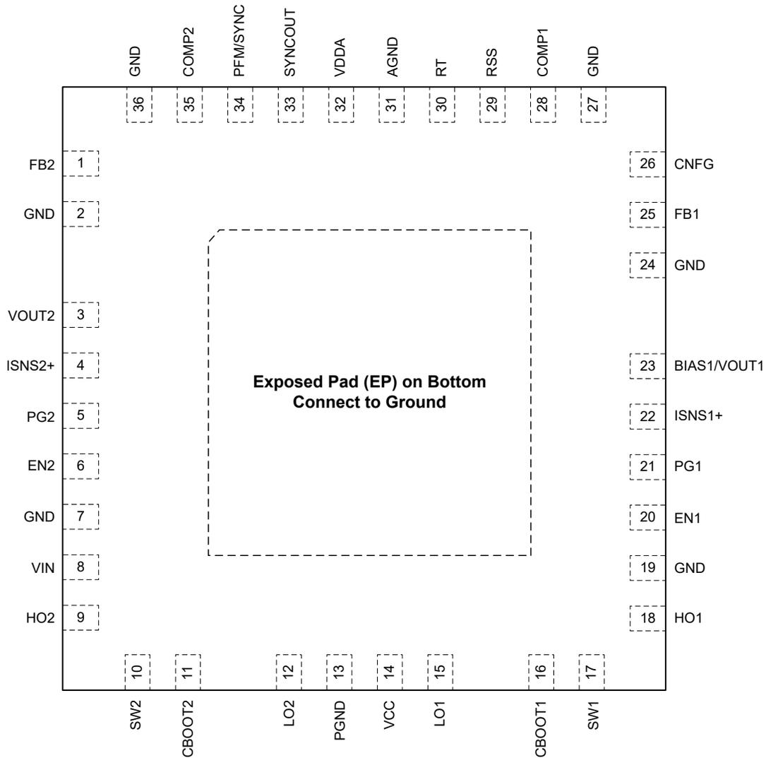
将底部的外露焊盘连接至 PCB 上的 AGND 和 PGND。
