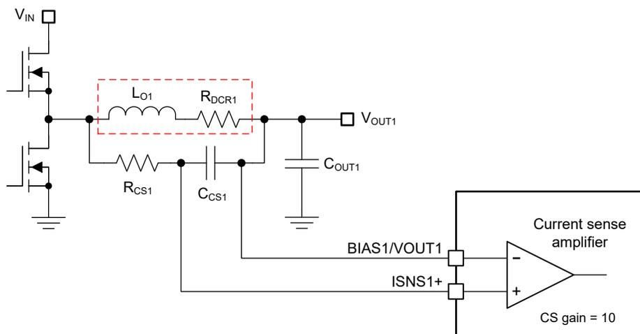
图 7-6. 电感器 DCR 电流检测实现方案
