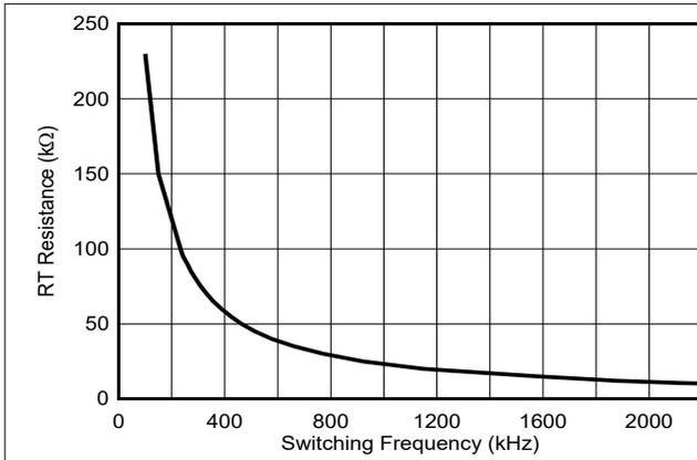
图 6-7. RT 电阻与开关频率间的关系
