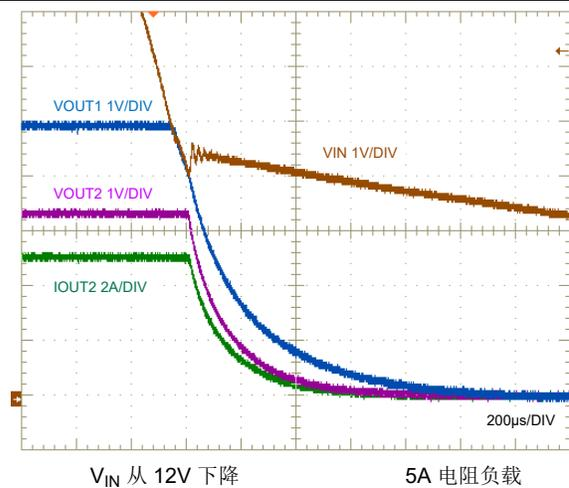
图 8-10. Ch1 和 Ch2 关断特性
