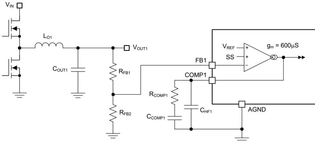
图 7-4. 具有可调输出设置的电压环路
