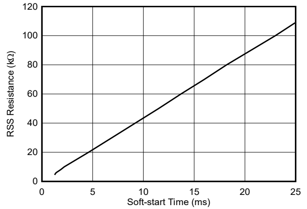
图 6-26. RSS 电阻与软启动时间间的关系
