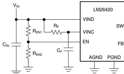
图 7-5. V<sub>in</sub> 控制 V<sub>OUT</sub>
