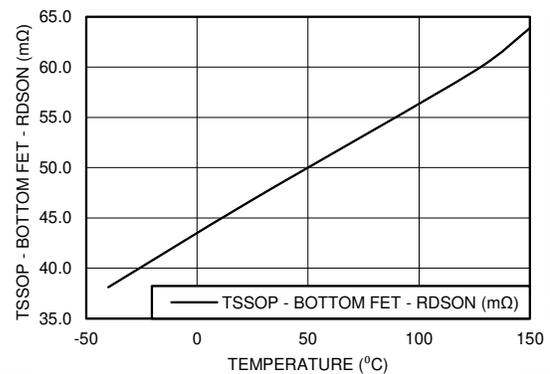
图 5-24. 底部  $R_{DS(on)}$  与温度间的关系 (Q0 级)
