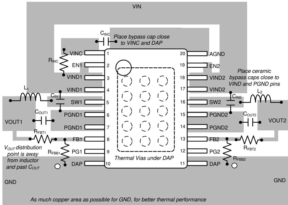
图 7-17. 直流/直流转换器的典型布局
