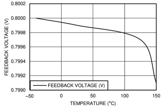
图 5-20.  $V_{FB}$  与温度间的关系 (Q0 级)
