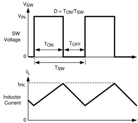
图 6-1. LM26420-Q1 PWM 比较器的基本运行
