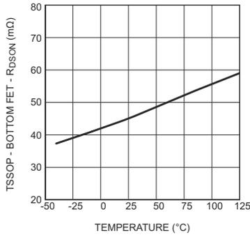
图 5-13. 底部  $R_{DSON}$  与温度间的关系 (HTSSOP-20 封装)
