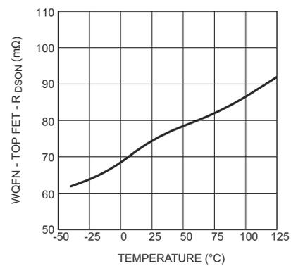
图 5-10. 顶部  $R_{DS(on)}$  与温度间的关系 (WQFN-16 封装)
