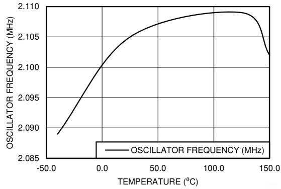
图 5-25. 振荡器频率与温度间的关系 (Q0 级)
