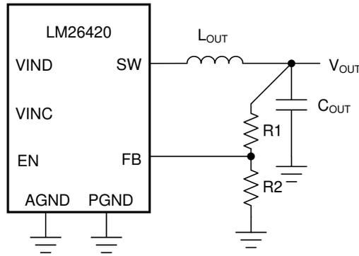
图 7-1. 对 V<sub>OUT</sub> 进行编程
