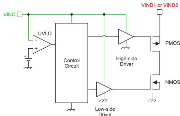
图 7-15. VINC、VIND<sub>1</sub> 和 VIND<sub>2</sub> 连接
