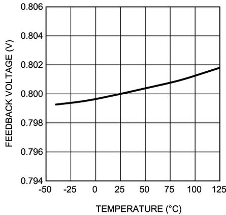
图 5-15.  $V_{FB}$  与温度间的关系
