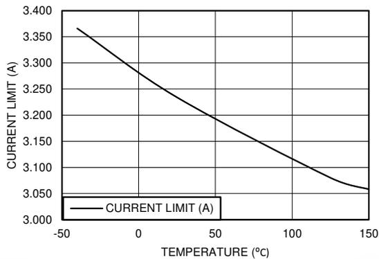
图 5-21. 电流限值与温度间的关系 (Q0 级)
