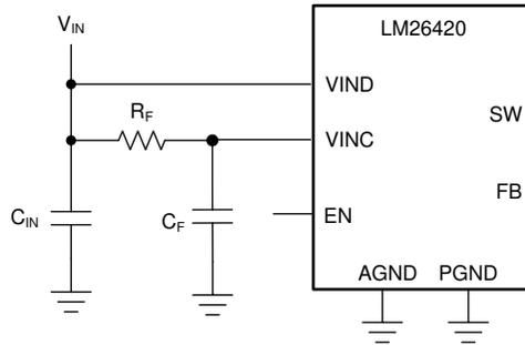
图 7-2. VINC 上的 RC 滤波器
