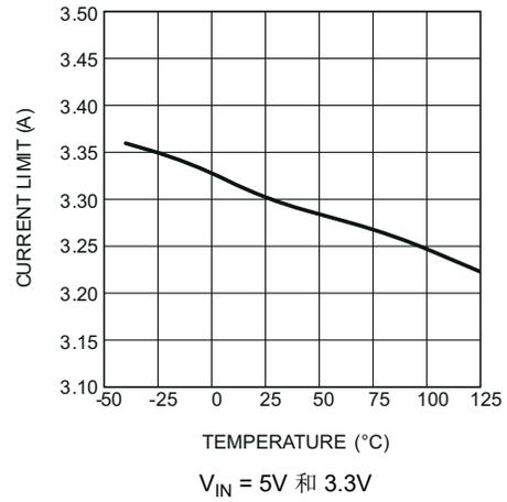
图 5-16. 电流限制与温度间的关系
