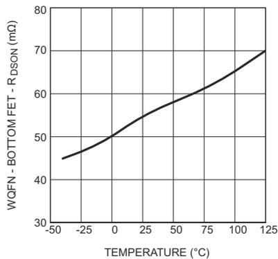
图 5-11. 底部  $R_{DS(on)}$  与温度间的关系 (WQFN-16 封装)
