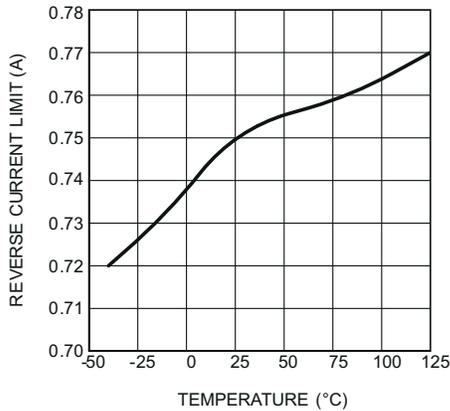
图 5-17. 反向电流限值与温度间的关系
