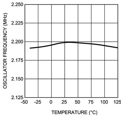
图 5-9. 振荡器频率与温度间的关系
