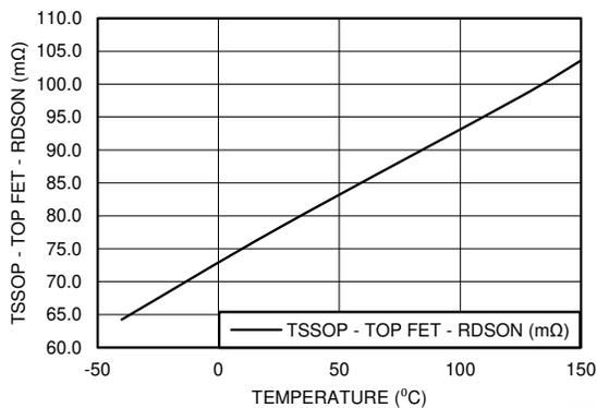
图 5-23. 顶部  $R_{DS(on)}$  与温度间的关系 (Q0 级)
