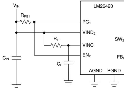
图 7-4. PG<sub>1</sub> 控制 V<sub>OUT2</sub>
