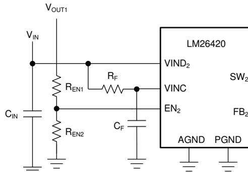
图 7-3.  $V_{OUT1}$  通过电阻分压器控制  $V_{OUT2}$
