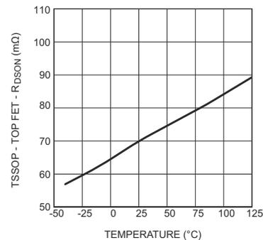
图 5-12. 顶部  $R_{DS(on)}$  与温度间的关系 (HTSSOP-20 封装)
