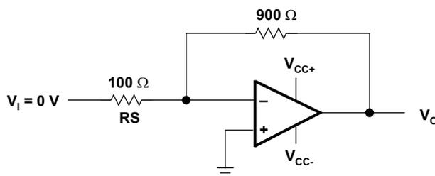
**Figure 2. Noise-Test Circuit**
