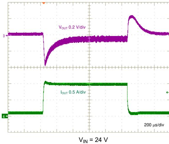
图 8-11. Load Transient, 0.1 A to 1 A, 0.1 A/μs
