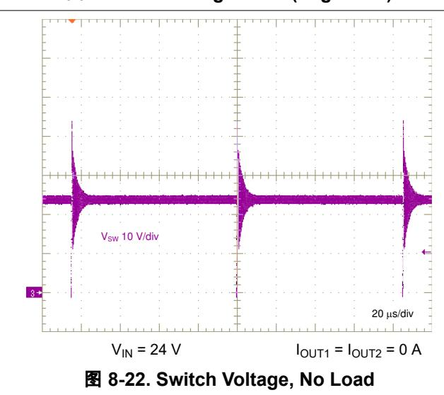
图 8-22. Switch Voltage, No Load
