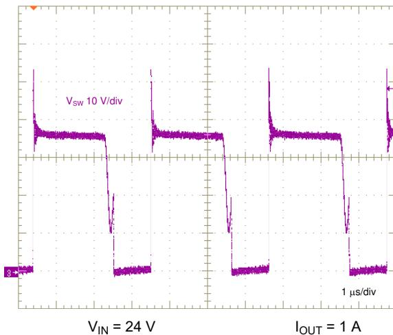
图 8-9. Switch Node Voltage
