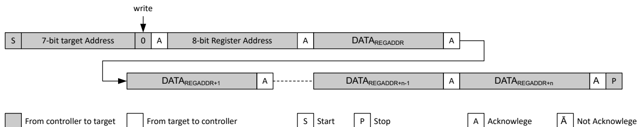
图 8-40. 在定义的寄存器地址开始进行顺序写入
