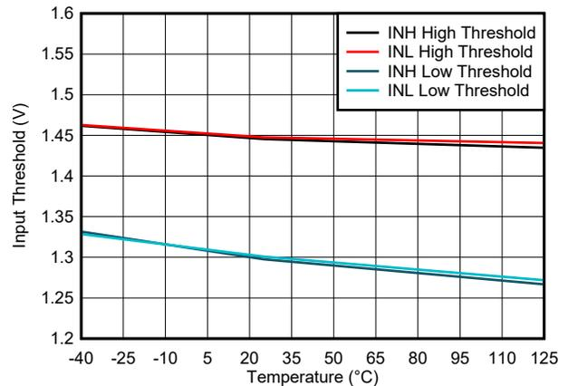
图 6-13. 输入电压阈值与温度间的关系
