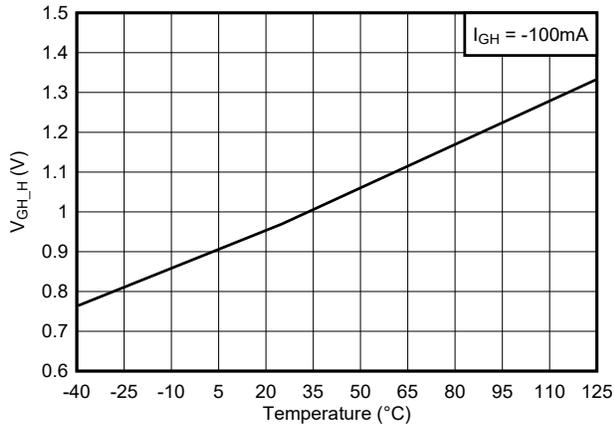
图 6-8. GH 输出高电压与温度间的关系
