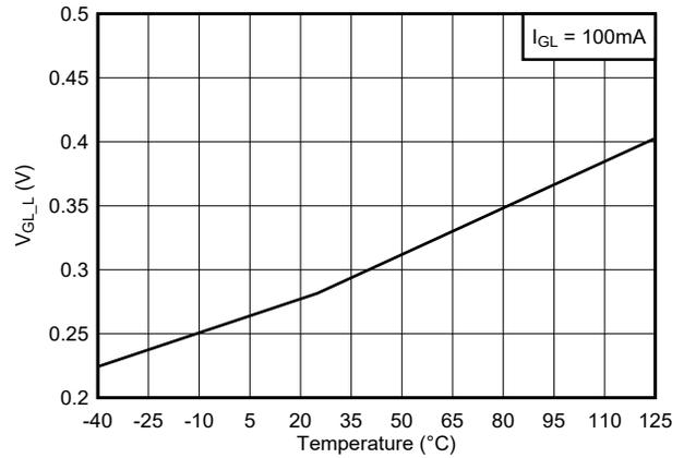
图 6-9. GL 输出低电压与温度间的关系
