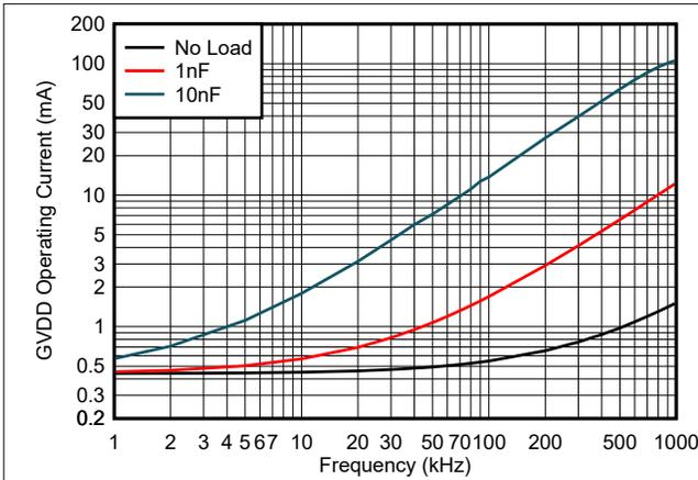
图 6-2. GVDD 工作电流与频率间的关系
