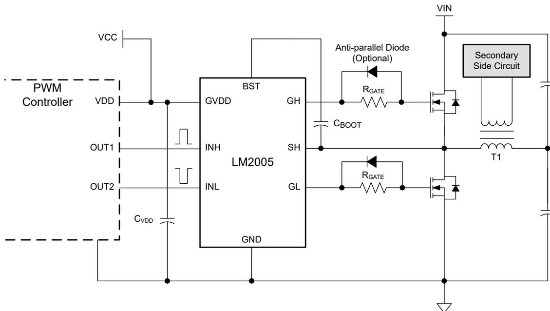
图 8-1. LM2005 在半桥转换器中驱动 MOSFET
