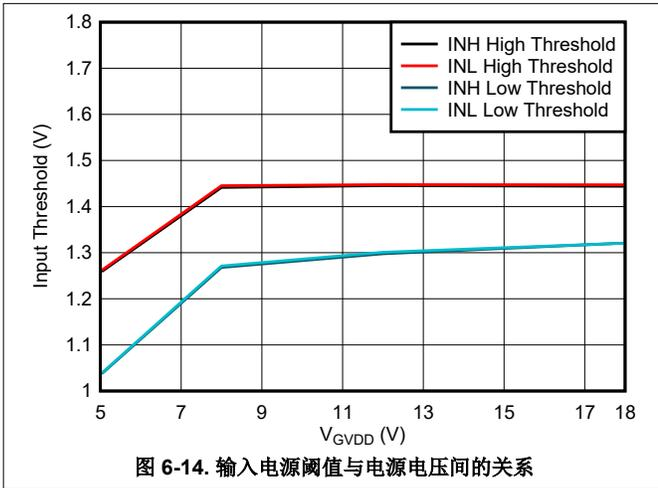
图 6-14. 输入电源阈值与电源电压间的关系
