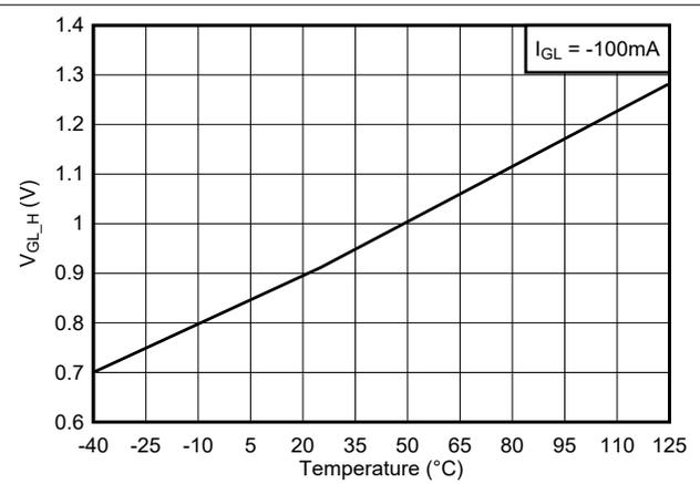
图 6-7. GL 输出高电压与温度间的关系
