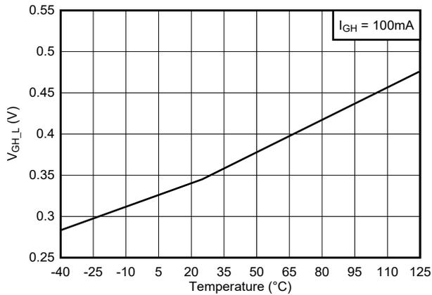
图 6-10. GH 输出低电压与温度间的关系
