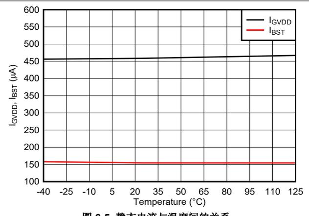
图 6-5. 静态电流与温度间的关系
