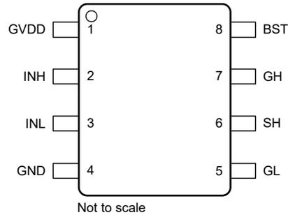
图 5-1. D 封装，8 引脚 SOIC ( 顶视图 )
