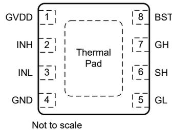
图 5-2. DSG 封装，8 引脚 WSON ( 顶视图 )
