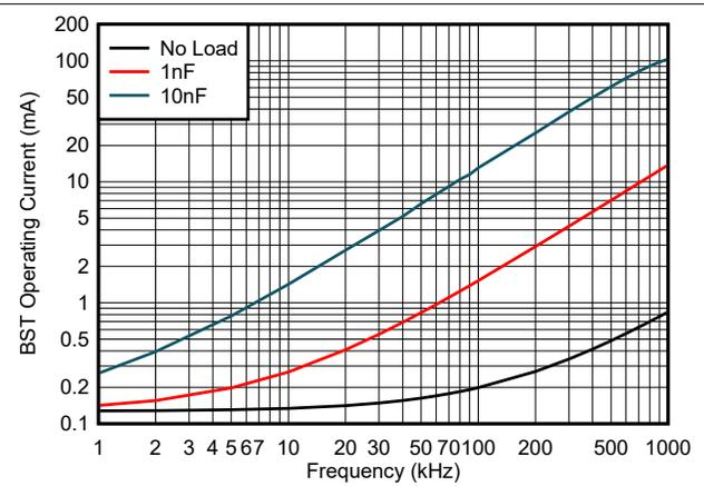
图 6-3. BST 工作电流与频率间的关系
