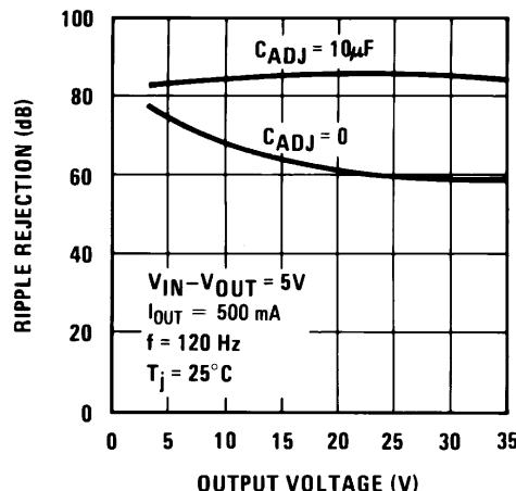
图 7-7. Ripple Rejection
