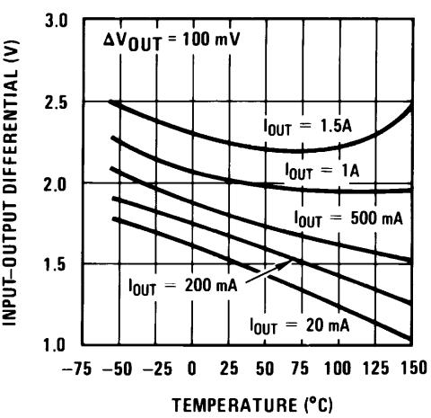
图 7-4. Dropout Voltage
