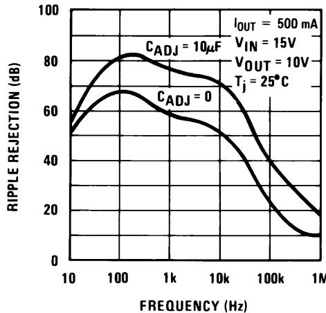
图 7-8. Ripple Rejection
