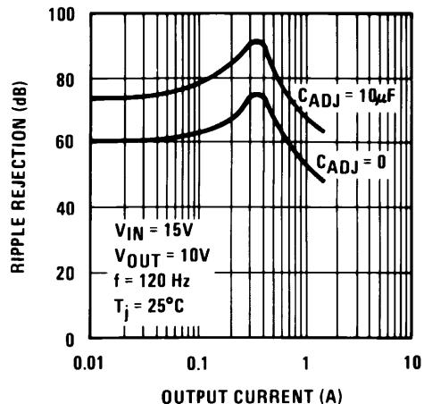
图 7-9. Ripple Rejection
