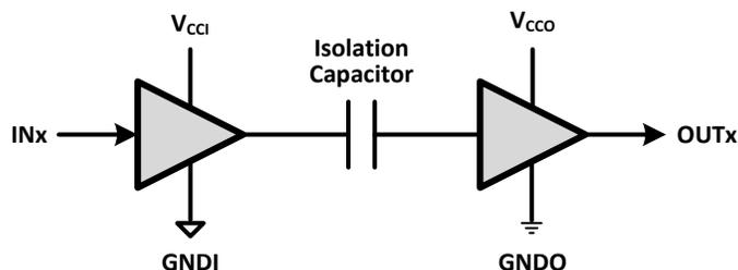
(1) V<sub>CCI</sub> 和 GNDI 分别是输入通道的电源和接地连接。
