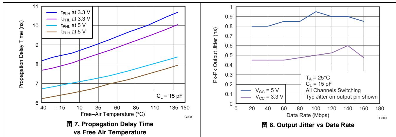
图 7. Propagation Delay Time
