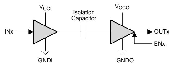
V<sub>CCI</sub> 和 GNDI 分别是输入通道的电源和接地连接。
