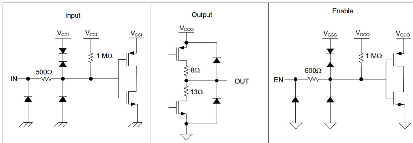
图 6-2. 器件 I/O 原理图
