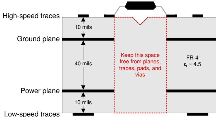
图 7-4. Recommended Layer Stack
