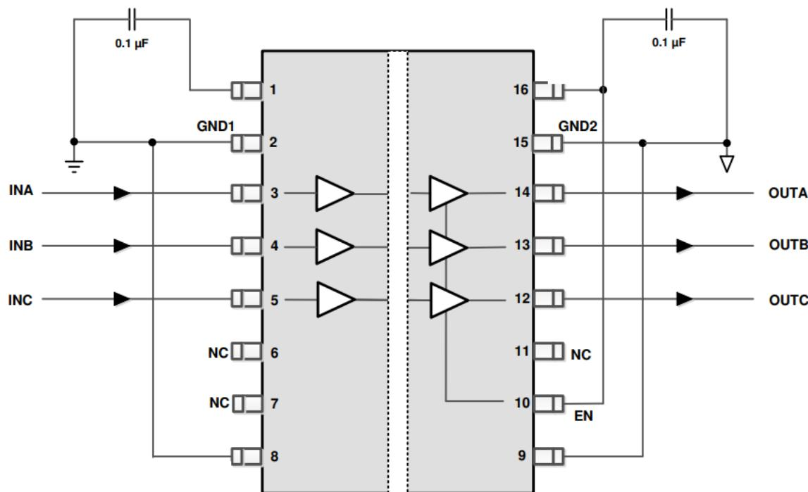
图 7-2. Typical ISO7231-Q1 Circuit Hook-up
