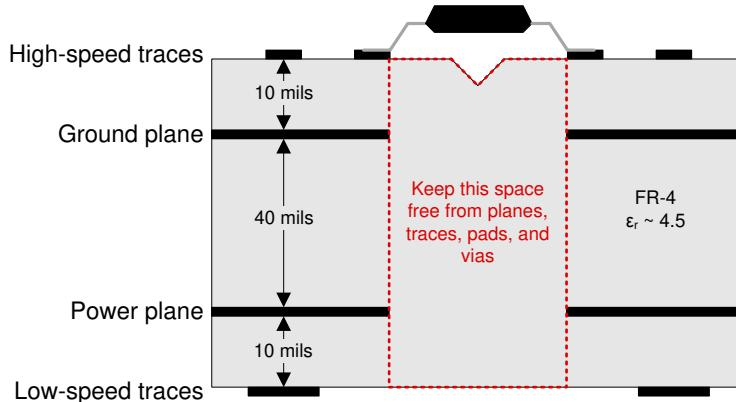
图 9-4. Recommended Layer Stack
