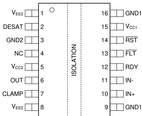
图 6-1. DW Package 16-Pin SOIC Top View
