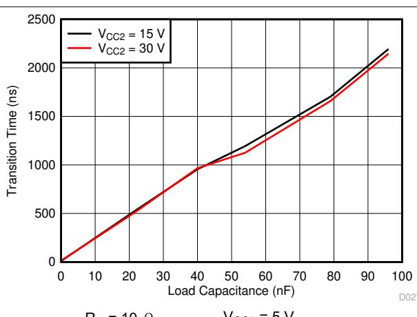
图 7-28.  $t_f$  Fall Time vs Load Capacitance
