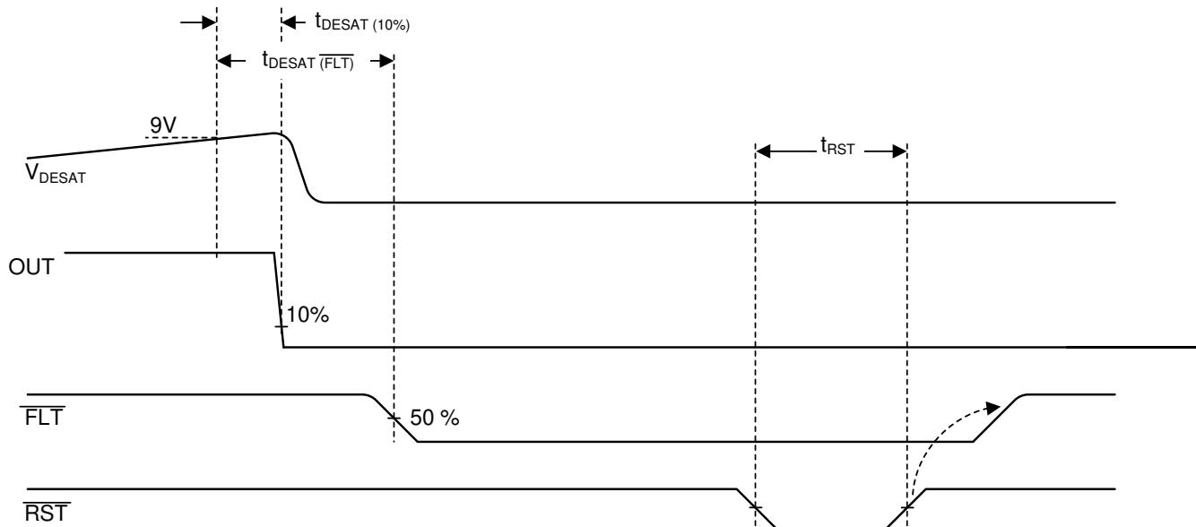
图 8-3. DESAT, OUT,  $\overline{FLT}$ ,  $\overline{RST}$  Delay
