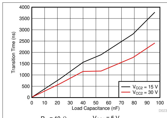
图 7-27.  $t_r$  Rise Time vs Load Capacitance
