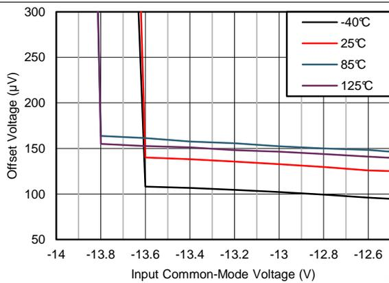
图 33. Offset Voltage vs Negative Common-Mode Voltage
