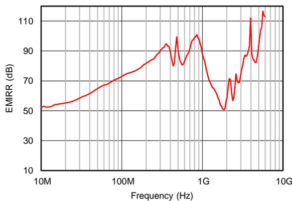
图 47. Common-Mode EMI Rejection Ratio
