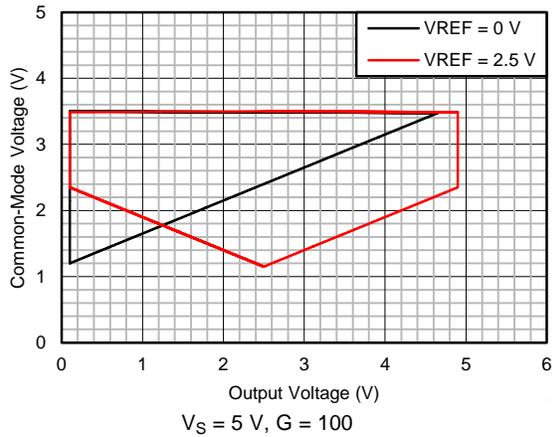
图 49. Input Common-Mode Voltage vs Output Voltage
