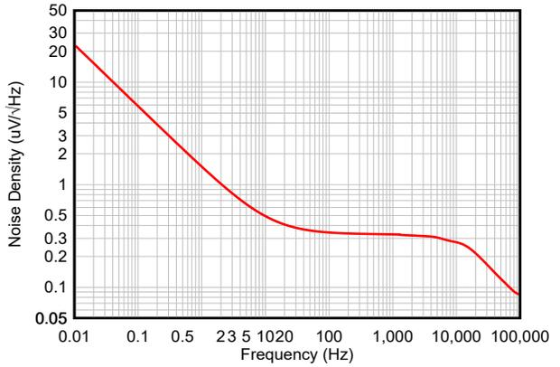
图 6-10. DAC 输出噪声密度与频率间的关系
