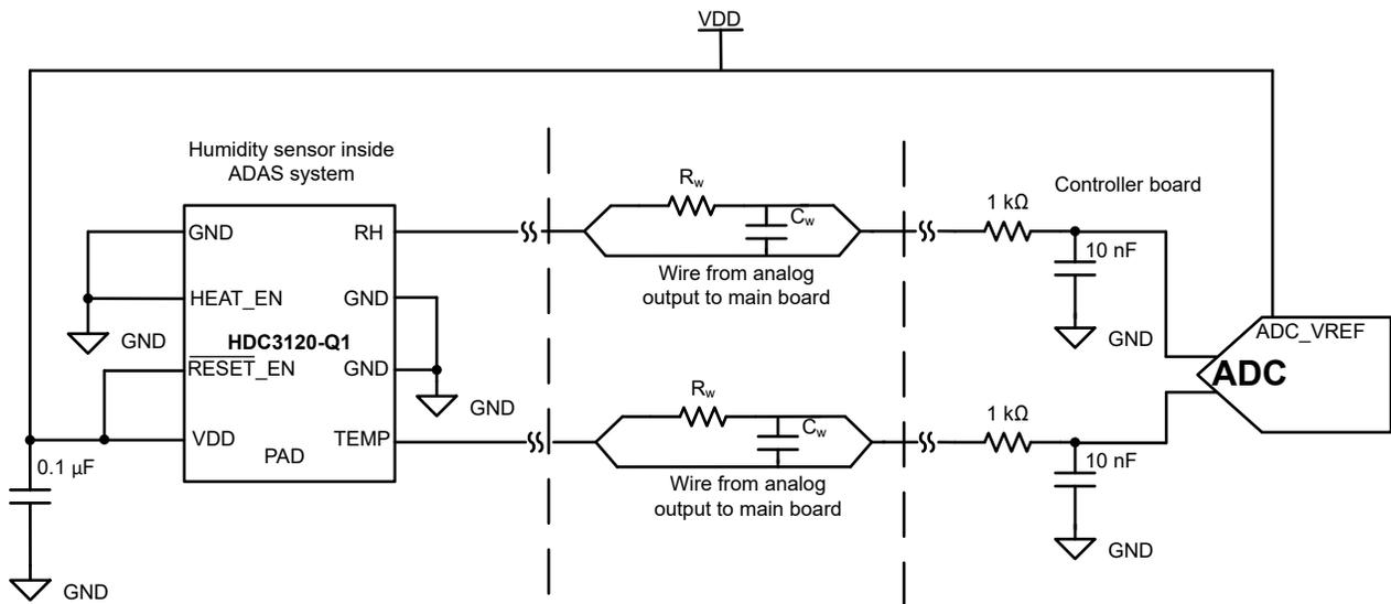
图 8-1. HDC3120-Q1 与 ADC 之间的连接
