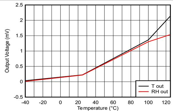
图 6-12. 禁用模式输出电压与温度间的关系
