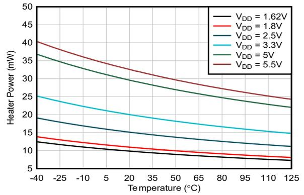
图 6-20. 加热器电流与温度间的关系
