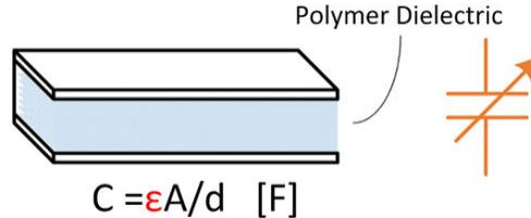
图 7-1. 带聚合物电介质的电容器
