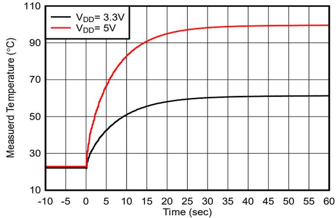
图 7-16. FlexPCB ( 0.13mm 柔性 ) 上的加热器感应温度升高
