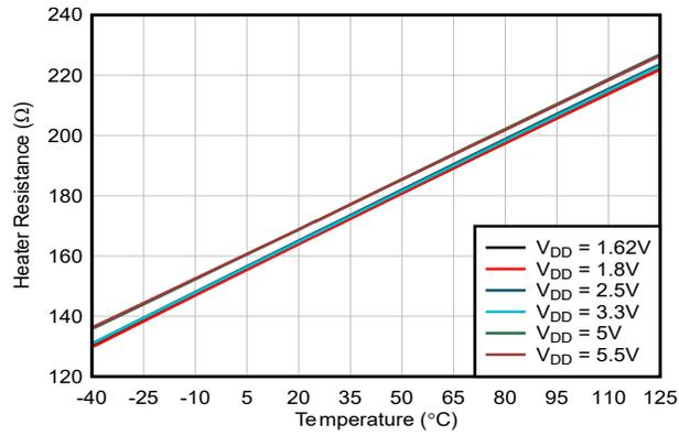
图 6-19. 加热器电阻与温度间的关系
