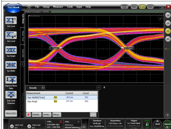
图 9. 5 Gbps Source Eye Diagram
