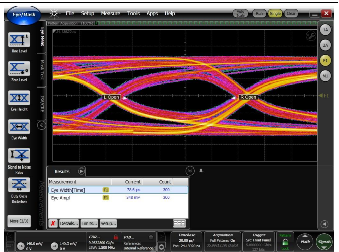
图 10. 5 Gbps Output Eye Diagram
