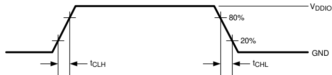
图 4-1. LVCMOS Transition Times
