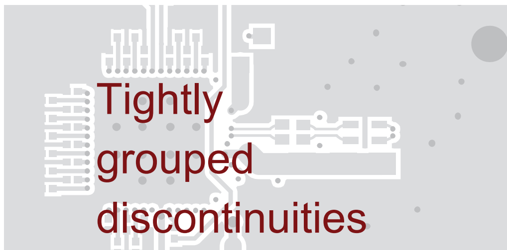
图 36. DS90UB921-Q1 Serializer Example Layout, Bottom Layer
